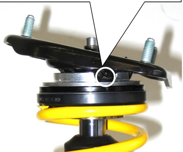
Das Anzugsdrehmoment der Kolbenstangenbefestigung beträgt 50 Nm. Die Montagehinweise zum Einbau des Federbeines in das Fahrzeug, sowie die Anzugsdrehmomente der Federbeinbefestigung, entnehmen Sie bitte den Unterlagen des Fahrzeugherstellers.
