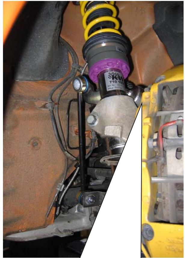
Bei Dämpferausführungen mit Druckausgleichsbehälter ist dieser zur Fahrzeugvorderseite zu montieren. Siehe Bild.
