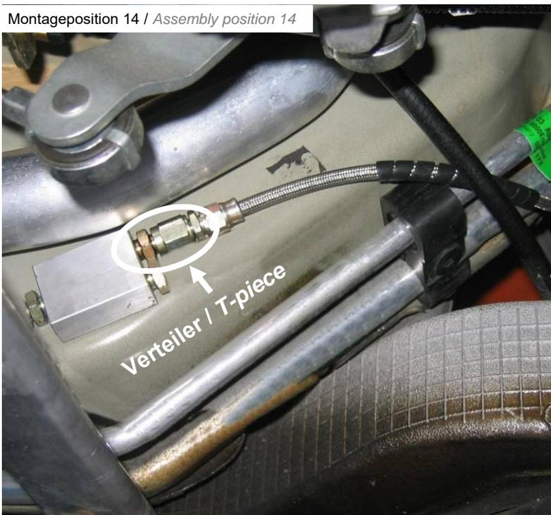
**Verlegung der Hydraulikleitung Hinterachse links Fahrzeugseite /
