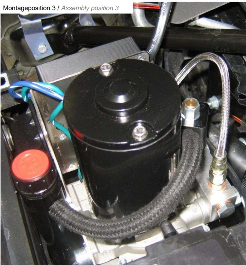
Anschließend Hydraulikleitung an dem zuvor montierten Adapter aufdrehen.
