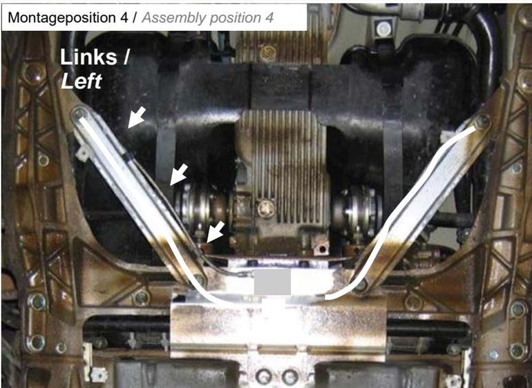
Hydraulikleitung (1200 mm) mit dem Verteiler verbinden. Anschließend Hydraulikleitung mit den mitgelieferten Edge Clips an den Streben befestigen. Kabelbinder erst nach vollständiger Leitungsverlegung festziehen.
