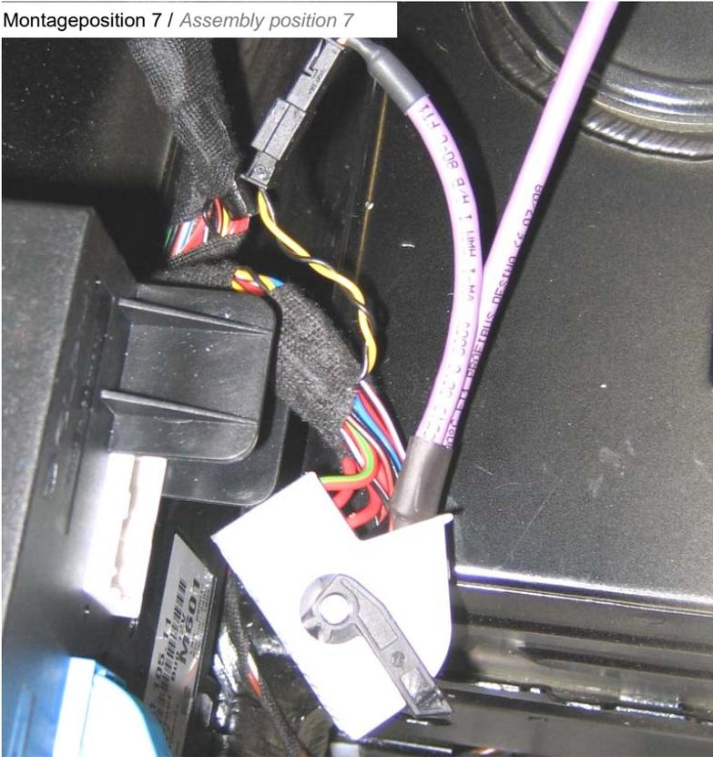
Steckergehäuse wieder anbringen und Stecker in das Steuergerät einstecken.
