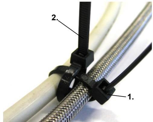
Hydraulikleitung (3320 mm) entlang der Wasserleitung verlegen und mit Kabelbinder befestigen.
