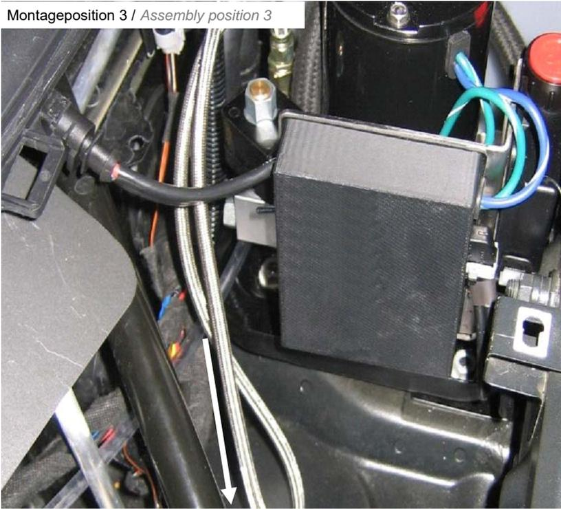
Hydraulikleitung entlang der Klimaleitung verlegen und mit Kabelbinder befestigen.
