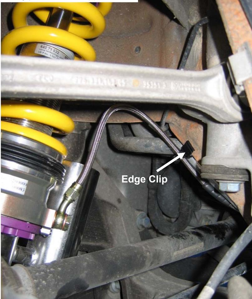
Hydraulikleitung (550 mm) am HLS Ringzylinder mit der mitgelieferten Hohl-schraube und 2 Dichtscheiben montieren. HLS Ringzylinder so positionieren, dass dieser mit der Hydraulikverschraubung zum Fahrzeuginnenseite zeigt.
