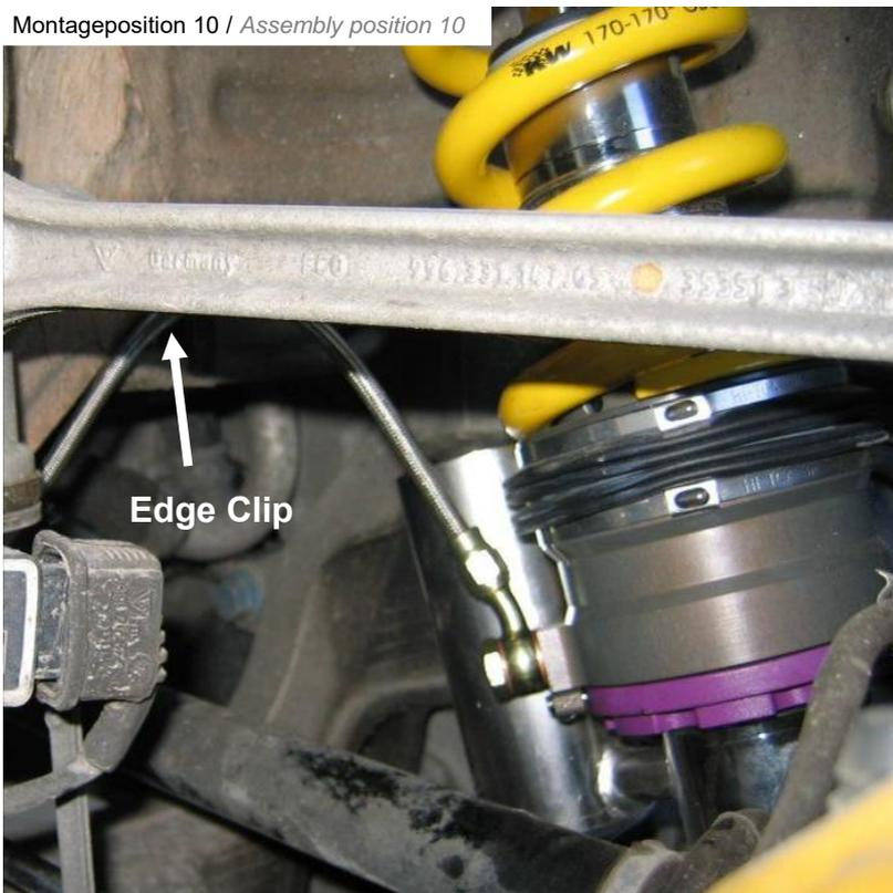
Hydraulikleitung (1340 mm) am HLS Ringzylinder mit der mitgelieferten Hohl-schraube und 2 Dichtscheiben montieren. HLS Ringzylinder so positionieren, dass dieser mit der Hydraulikverschraubung zum Fahrzeuginnenseite zeigt.
