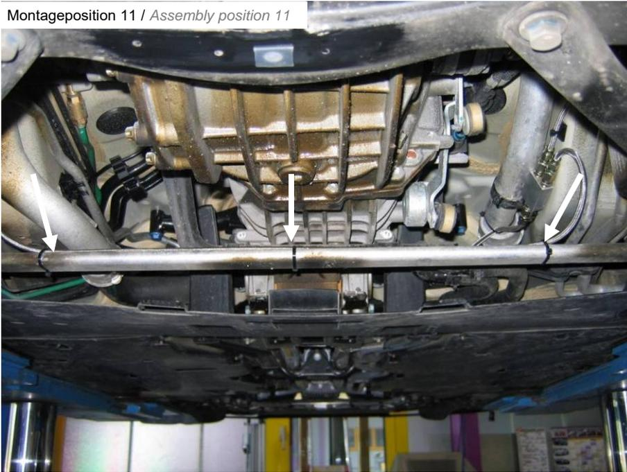
Hydraulikleitung ( 1340mm) mit dem Verteiler verbinden. Anschließend Hydraulikleitung mit den mitgelieferten Kabelbinder an der Strebe befestigen. Kabelbinder erst nach vollständiger Leitungsverlegung festziehen.
