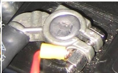
Masseleitung und Plusleitung an der Batterie anklammern.
