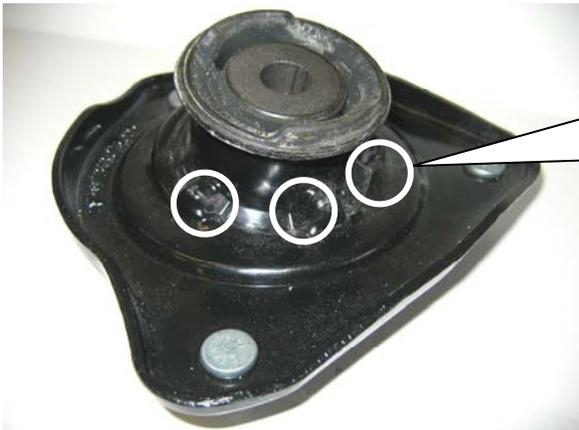
Original Stützlager aufstecken. Dabei ist darauf zu achten, dass die Einkerbungen am Federteller mit der Erhebungen am Stützlager übereinstimmen.
