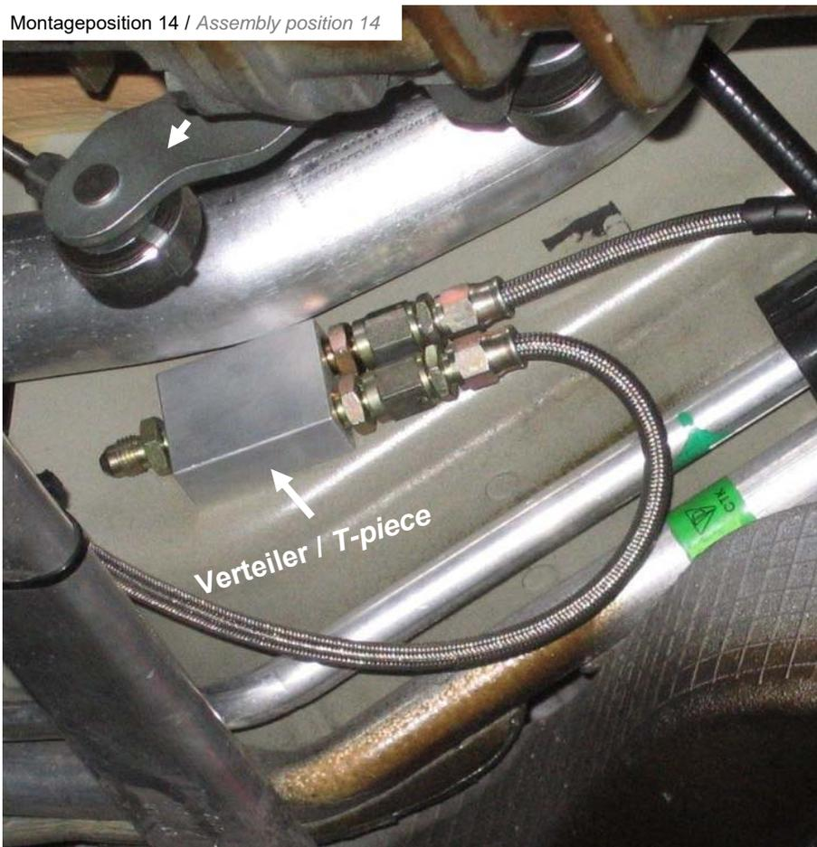
**Verlegung der Hydraulikleitung von dem Hydraulikaggregat zum HA Verteiler /
