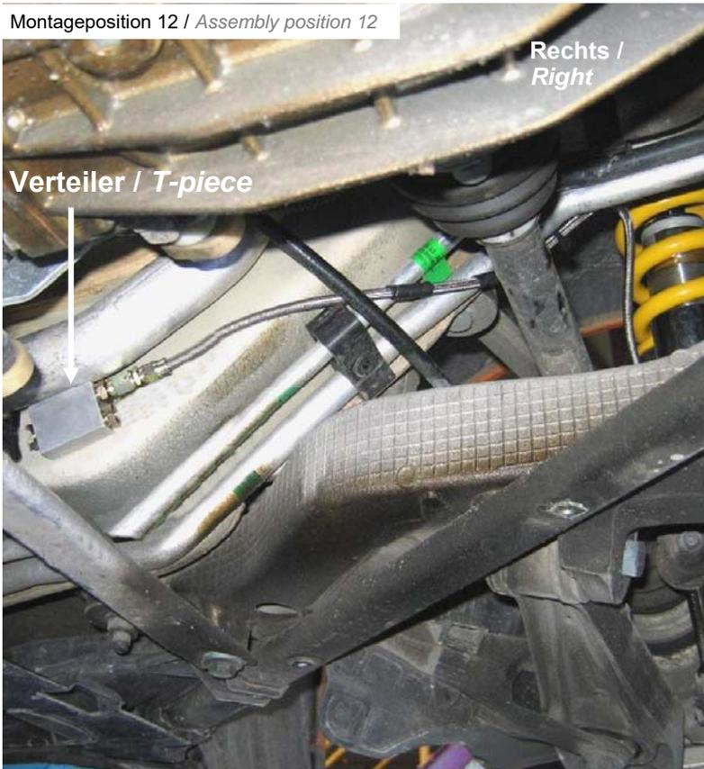
Hydraulikleitung (550 mm) mit dem Verteiler verbinden. Anschließend Hydraulikleitung mit den mitgelieferten Kabelbinder befestigen. Kabelbinder erst nach vollständiger Leitungsverlegung festziehen. Sollte es vorkommen, dass die Hydraulikleitung über einer Scharfen Kante verläuft, ist die Hydraulikleitung mit dem Spiralband zu schützen.
