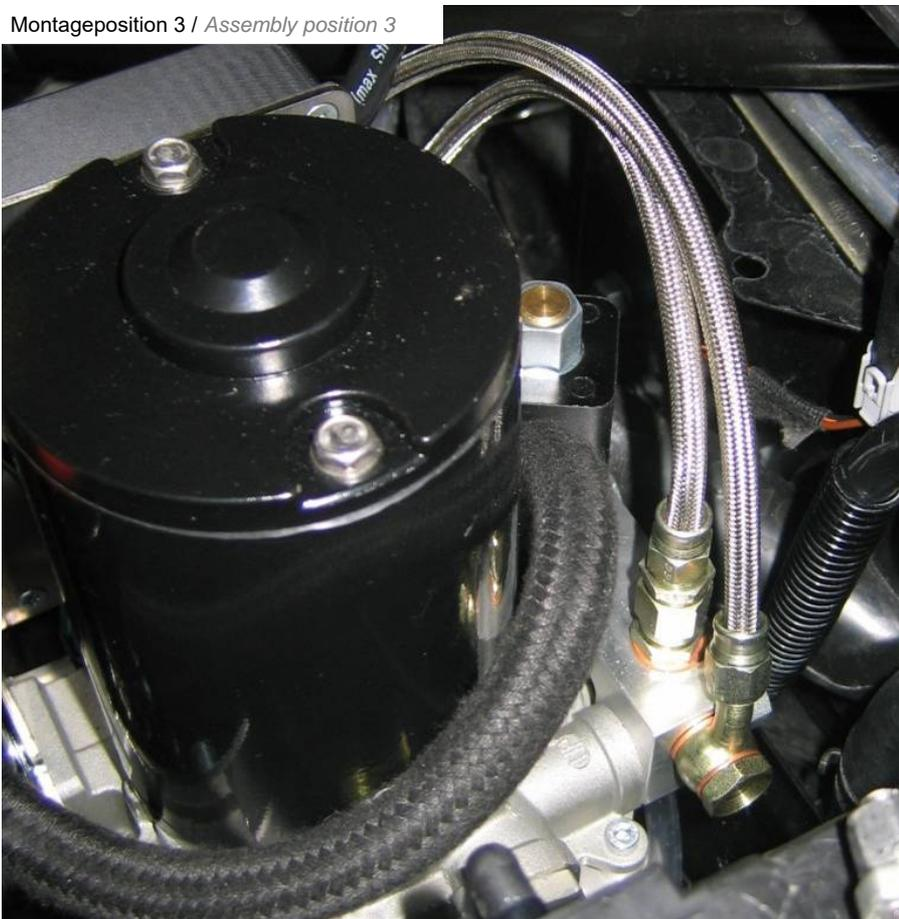
Mitgelieferten Hydraulikleitung (3220 mm) mit 2 Dichtscheiben montieren.
