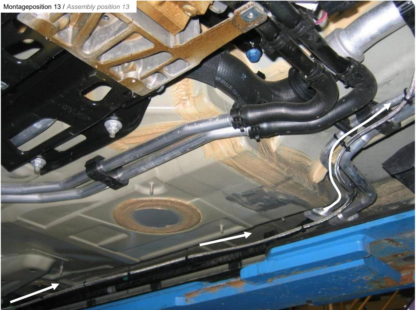
Hydraulikleitung (3320 mm) mit dem Verteiler verbinden. Anschließend Hydraulikleitung mit den mitgelieferten Kabelbinder an der Kühlwasserleitung befestigen. Kabelbinder erst nach vollständiger Leitungsverlegung festziehen. Sollte es vorkommen, dass die Hydraulikleitung über einer Scharfen Kante verläuft, ist die Hydraulikleitung mit dem Spiralband zu schützen.
