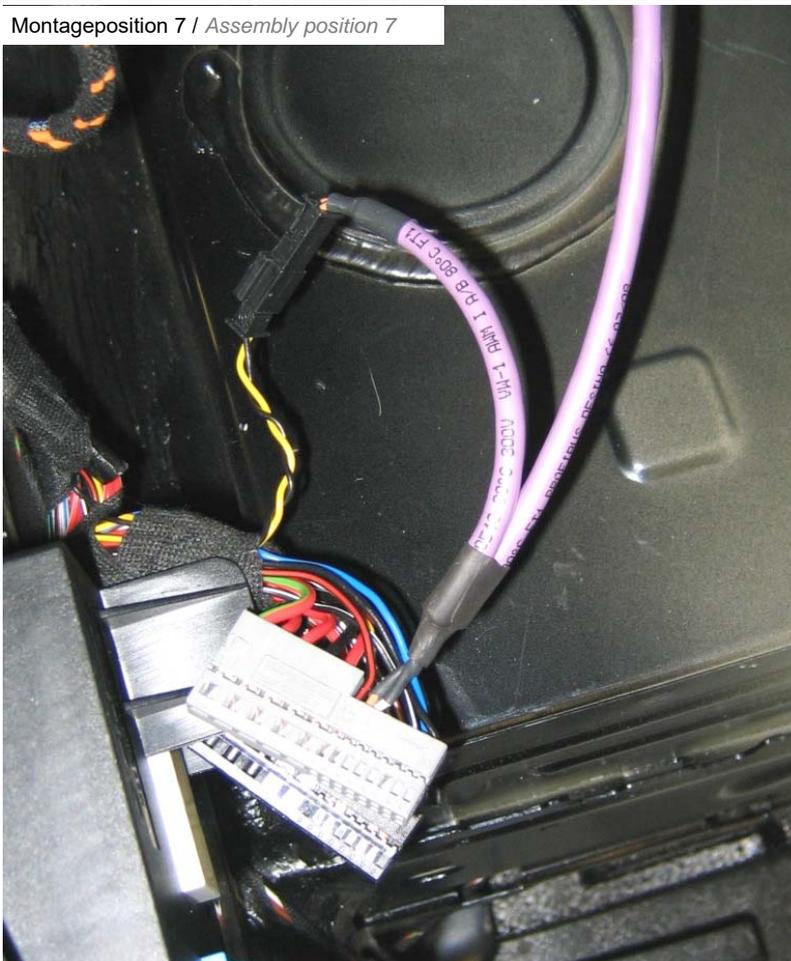
Anschließend die vom Y-Adapter abgehenden Kabel **Pin 1** und **Pin 2** in den Originalstecker einstecken.
