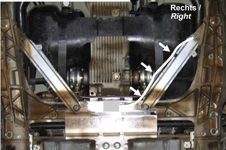
Hydraulikleitung (1200 mm) mit dem Verteiler verbinden. Anschließend Hydraulikleitung mit den mitgelieferten Edge Clips an den Streben befestigen. Kabelbinder erst nach vollständiger Leitungsverlegung festziehen.
