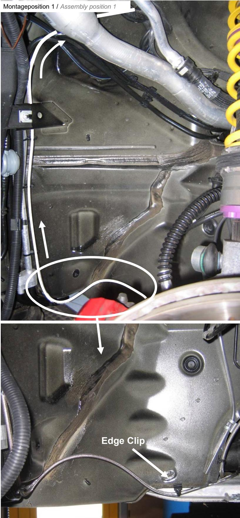
Hydraulikleitung entlang der Klimaleitung verlegen und mit Kabelbinder befestigen.
