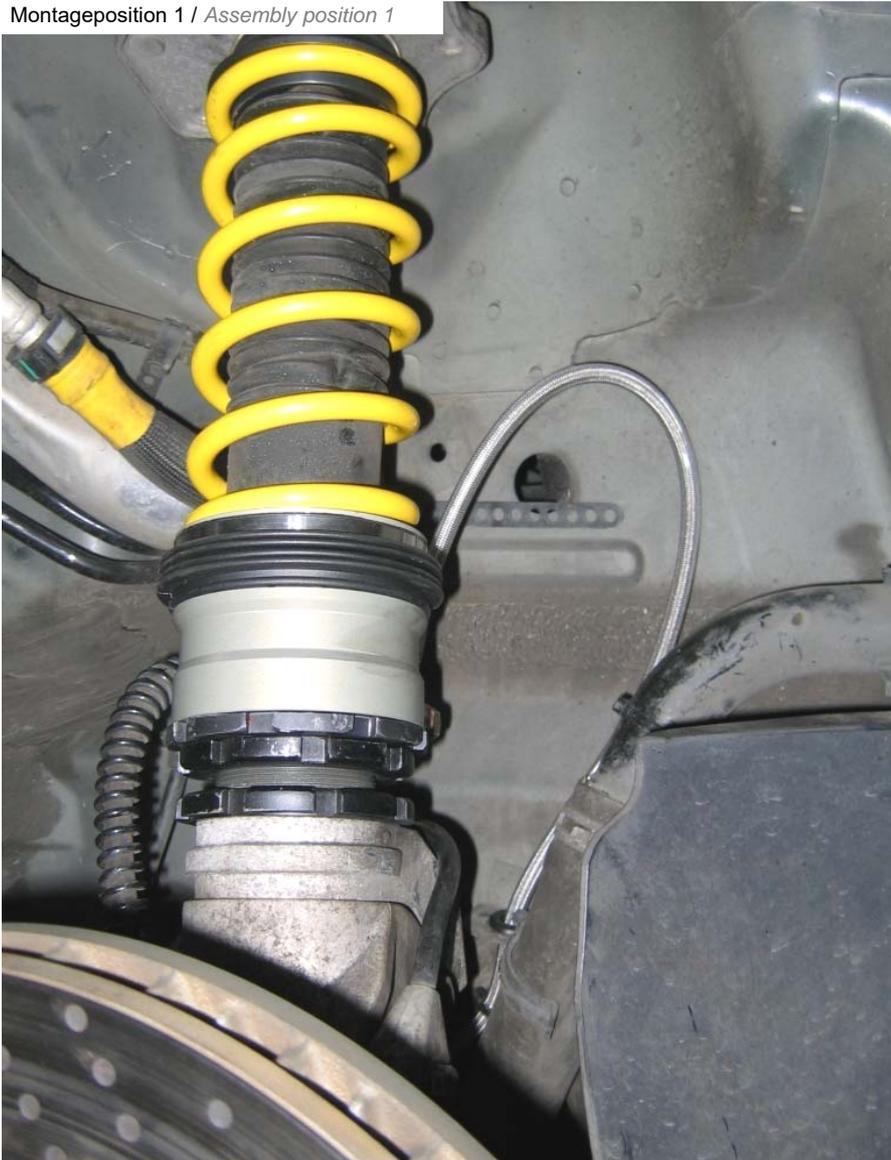
Hydraulikleitung (1200 mm) am HLS Ringzylinder mit der mitgelieferten Hohlsschraube und 2 Dichtscheiben montieren.
