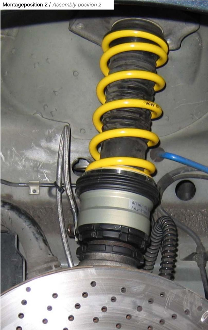
Hydraulikleitung (1200 mm) am HLS Ringzylinder mit der mitgelieferten Hohl-schraube und 2 Dichtschieben montieren.
