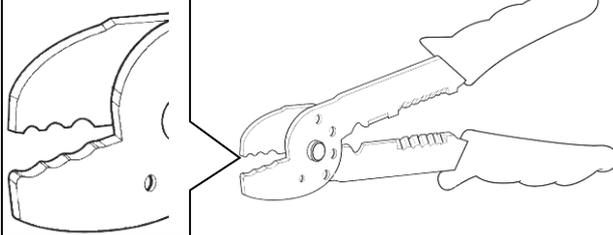
Masseleitung (blau) 8 mm abisolieren und mitgelieferten Kabelschuh mit geeignetem Werkzeug an der Masseleitung (blau) montieren.
