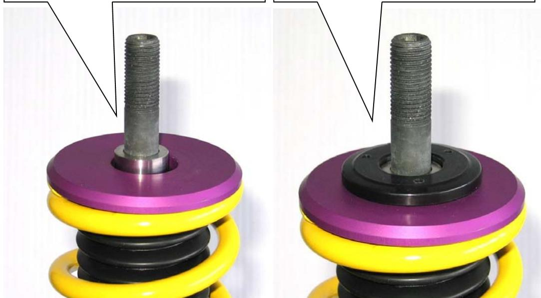
Serien Stützlager aufstecken und mit der Original Mutter verschrauben. Die Montagehinweise zum Einbau des Federbeines in das Fahrzeug, sowie die Anzugsdrehmomente der Federbeinbefestigung, entnehmen Sie bitte den Unterlagen des Fahrzeugherstellers.
