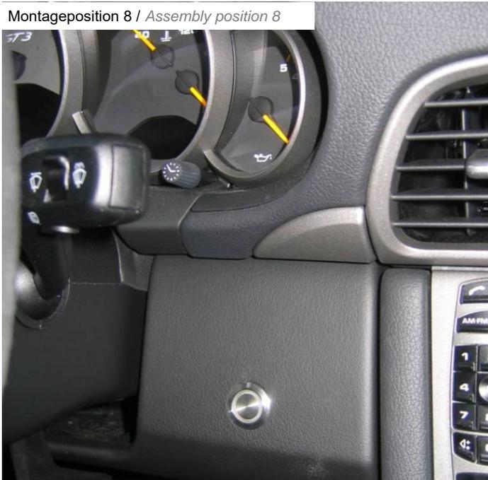
Für die Montage des Tasters muss ein Loch in das Armaturenbrett gebohrt werden.
