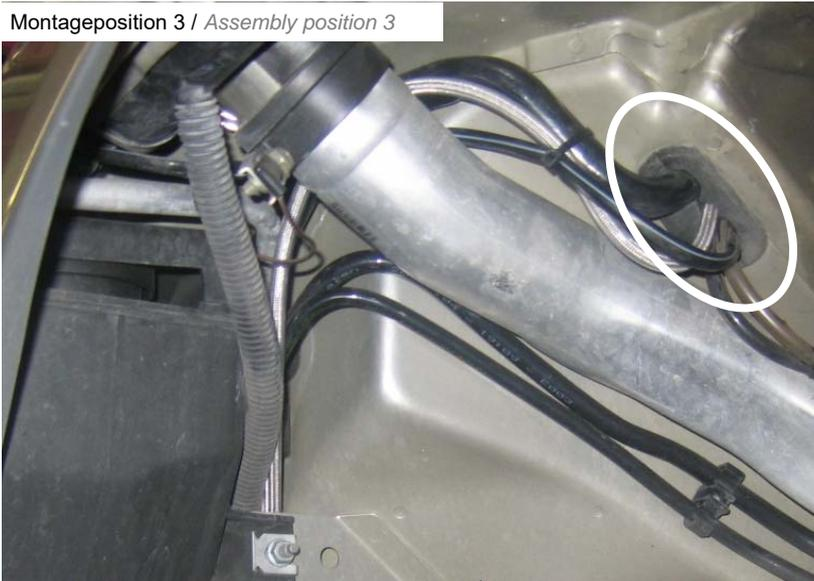
Hydraulikleitung durch die serienmäßige Öffnung entlang der Klimaleitung verlegen und mit Kabelbinder befestigen.
