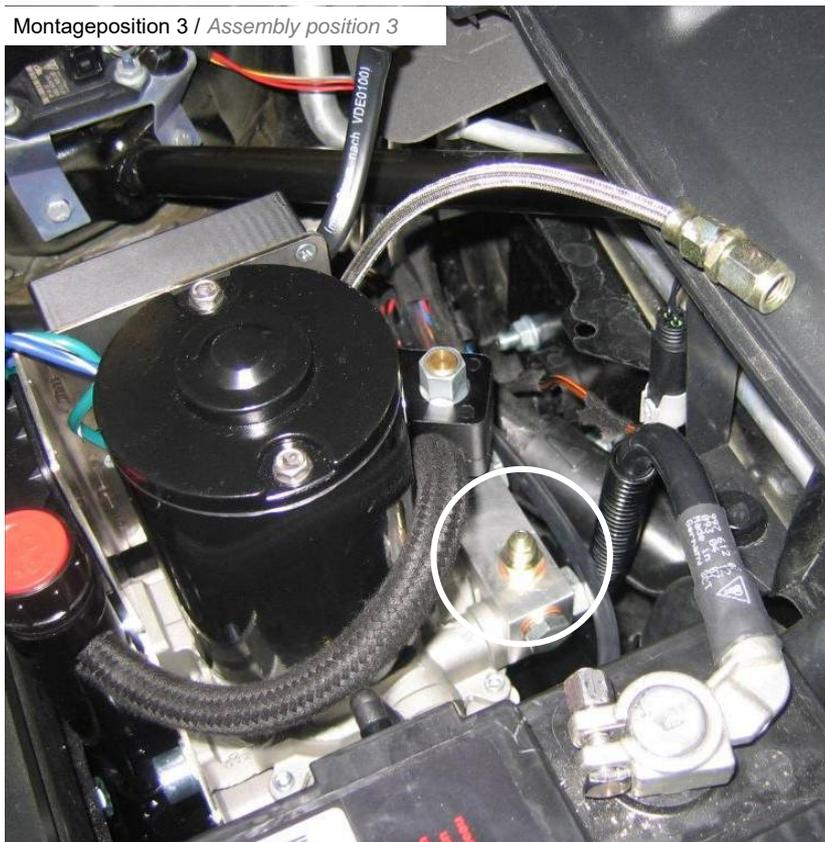
Mitgelieferten Anschlussadapter mit einer Dichtscheibe montieren.
