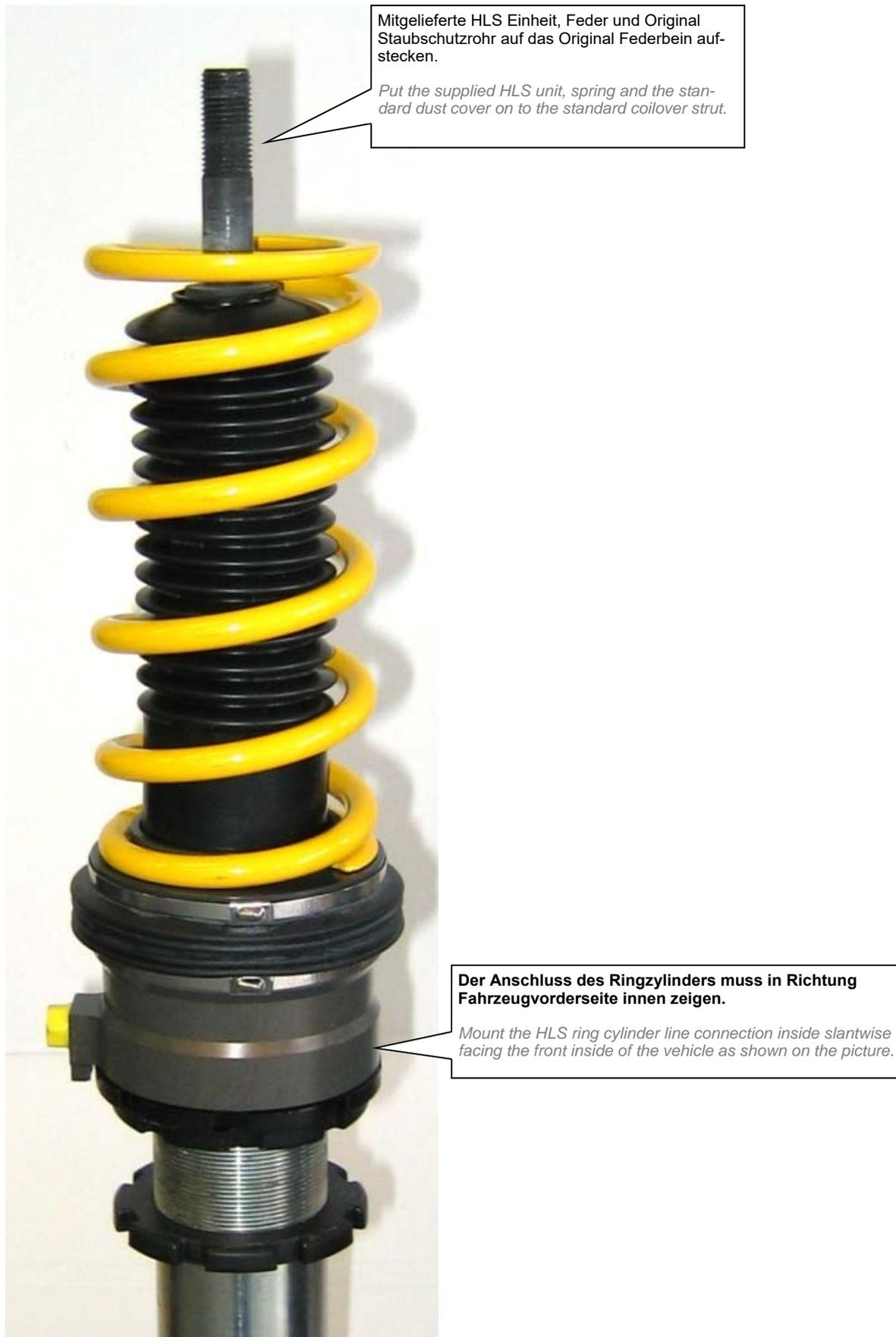
Mitgelieferte HLS Einheit, Feder und Original Staubschutzrohr auf das Original Federbein aufstecken.
