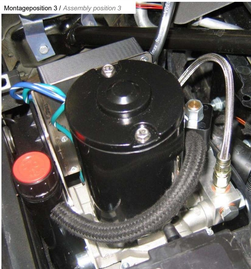
Anschließend Hydraulikleitung an dem zuvor montierten Adapter aufdrehen.
