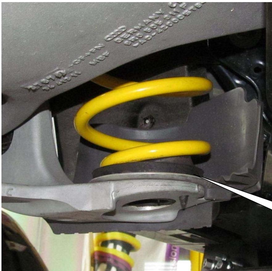
Am unteren Ende der Feder wird die originale Federunterlage weiterverwendet.
