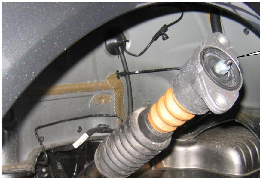
Stützlager mit geeignetem Werkzeug demontieren.
