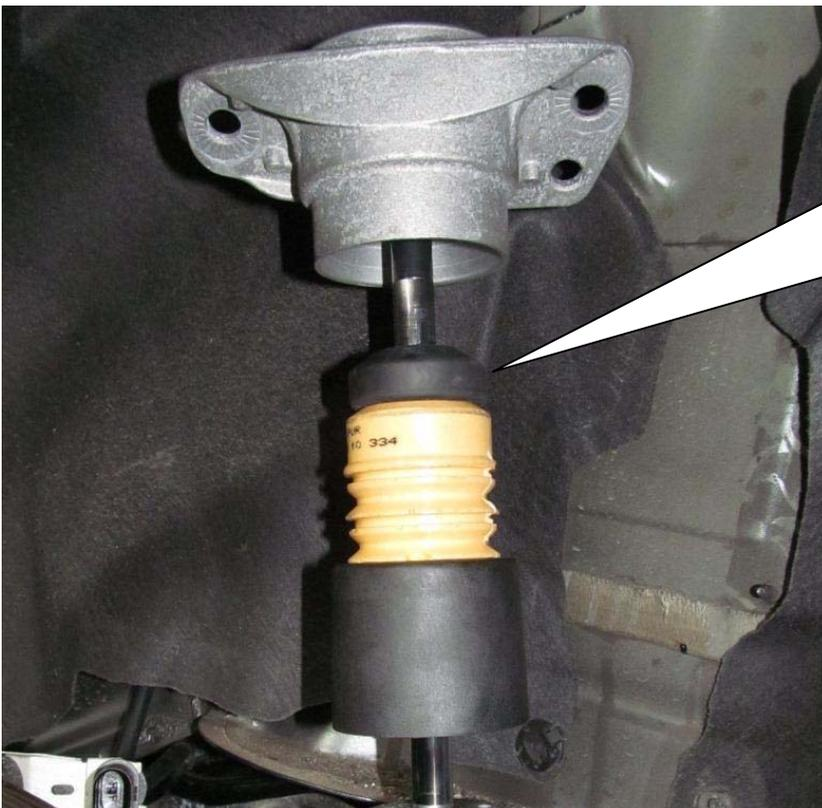
Original Stützlager aufstecken und mit der Original Mutter verschrauben. Die Montagehinweise zum Einbau des Dämpfers in das Fahrzeug, sowie die Anzugsdrehmomente der Dämpferbefestigung, entnehmen Sie bitte den Unterlagen des Fahrzeugherstellers.
