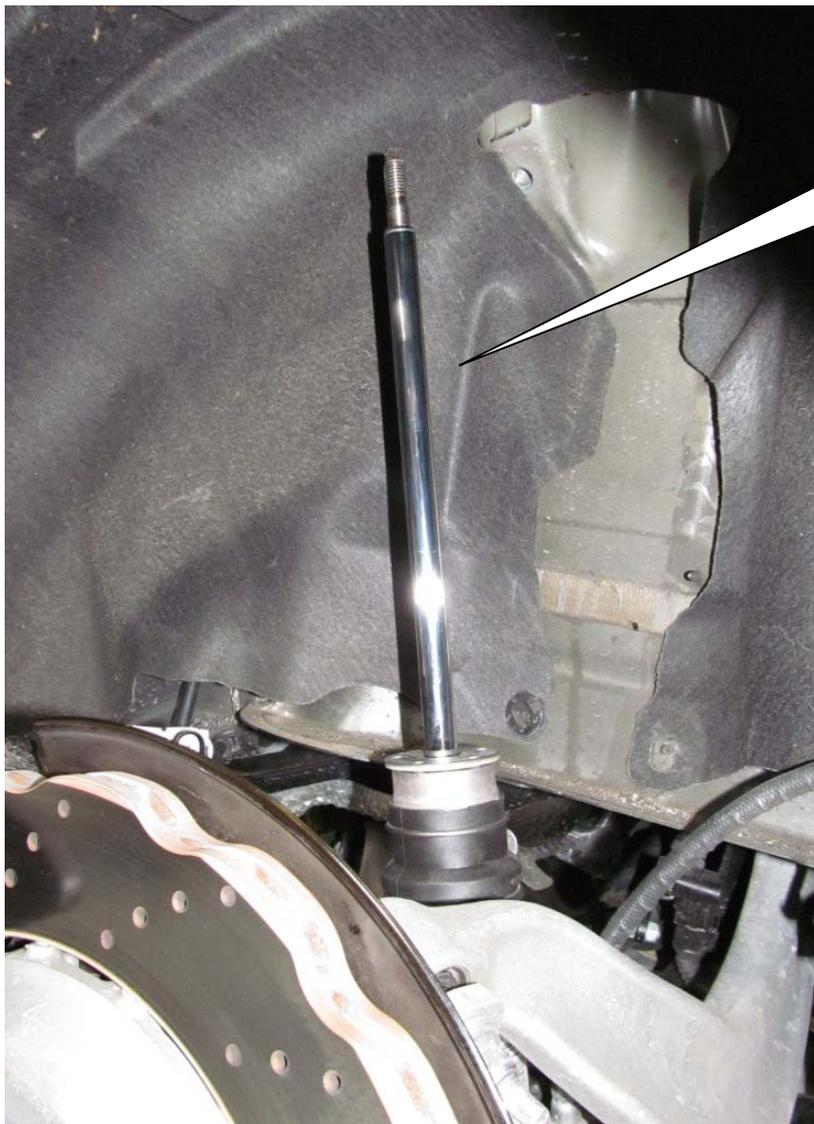
Original Staubschutzrohr und Anschlagelement entfernen.
