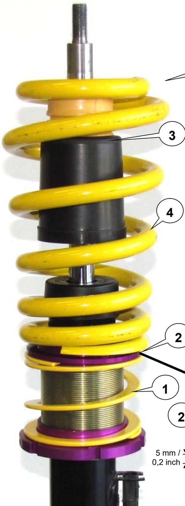
Zwischenring mit dem schmalen Bund in Richtung Helferfeder montieren.
