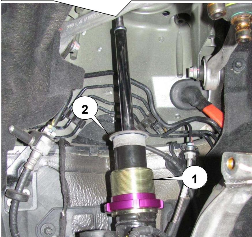
Folgende mitgelieferte Teile in der Reihenfolge auf das Federbein aufstecken: Vorspannfeder 1, Zwischenring 2, Anschlagelement mit Staubschutz 3, und Hauptfeder 4.
