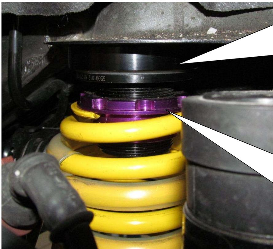
Die Höhenverstellung mit Scheibe wird oben eingesetzt, die serienmäßige obere Federunterlage wird nicht mehr verwendet. Zwischen Höhenverstellung und Karosserie wird die mitgelieferte Aluminiumdistanz montiert.
