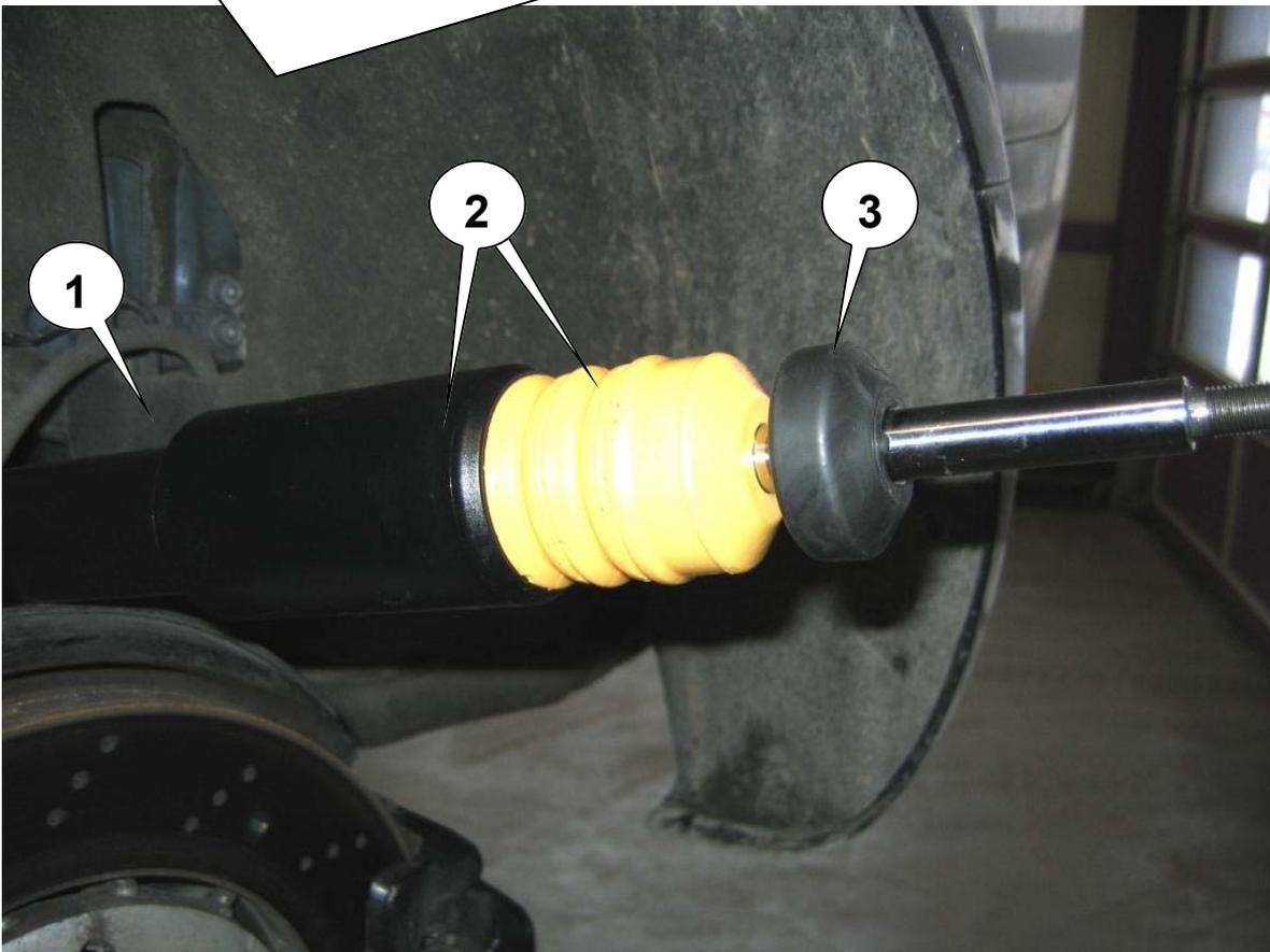
Original Stützlager aufstecken und mit der Original Mutter verschrauben. Die Montagehinweise zum Einbau des Dämpfers in das Fahrzeug, sowie die Anzugsdrehmomente der Dämpferbefestigung, entnehmen Sie bitte den Unterlagen des Fahrzeugherstellers.
