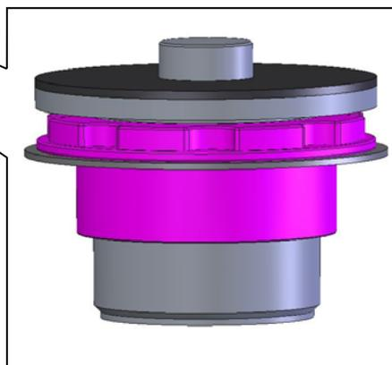
Am unteren Ende der Feder wird die originale Federunterlage weiterverwendet.
