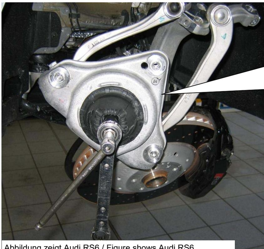
Stützlager mit geeignetem Werkzeug demontieren.
