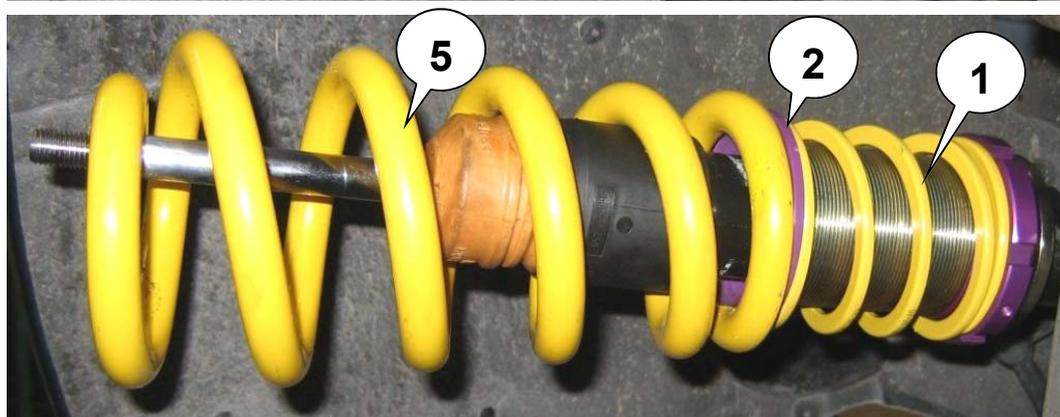
Original Stützlager mit Gummiunterlage aufstecken und mit der Original Mutter verschrauben. Die Montagehinweise zum Einbau des Federbeines in das Fahrzeug, sowie die Anzugsdrehmomente der Federbeinbefestigung, entnehmen Sie bitte den Unterlagen des Fahrzeugherstellers.
