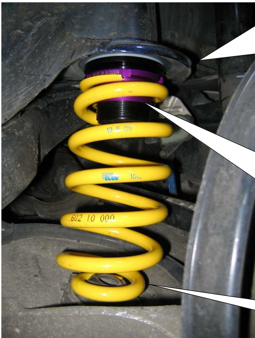
Die Höhenverstellung mit Scheibe wird oben eingesetzt, die serienmäßige obere Federunterlage wird nicht mehr verwendet. Zwischen Höhenverstellung und Karosserie wird die mitgelieferte Kunststoffscheibe montiert.
