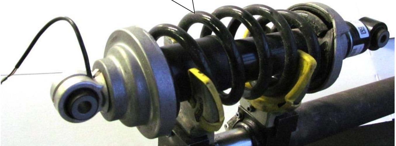
Sicherungsring / Spannring aus der Nut ganz nach unten verschieben.
