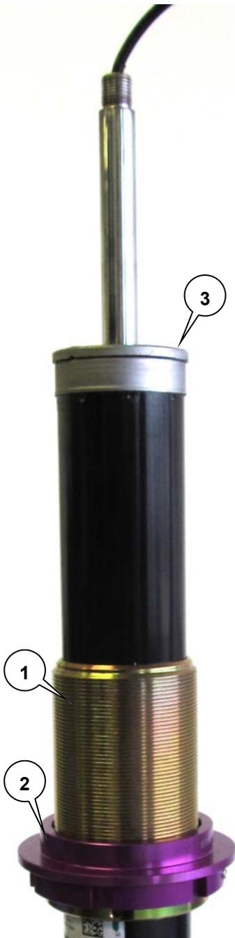
Zwischenring mit dem schmalen Bund in Richtung Helferfeder montieren.
