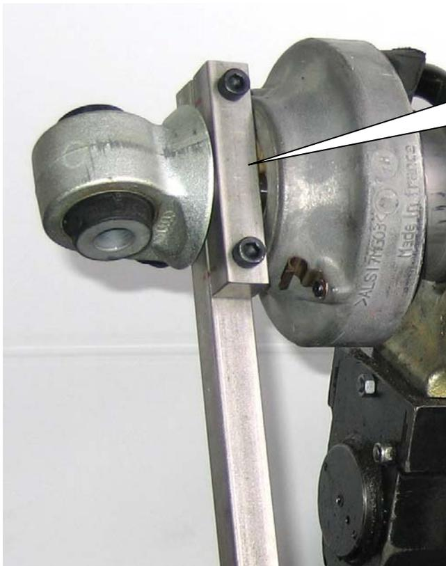
Mitgeliefertes Spezialwerkzeug an der Kolbenstange des Dämpfers montieren.
