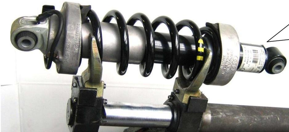
Feder mittels eines GS geprüften Federspanner vorspannen. Leitungsverlegung und Position der Leitungshalter am oberen Federteller notieren.
