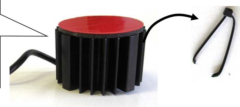
Originale Dämpfersteuerungsleitung in die mitgelieferte Stilllegung einstecken. Auf die korrekte Verriegelung des Steckers achten! Stilllegung mit dem Klebeband an der Fahrzeugkarosserie befestigen.
