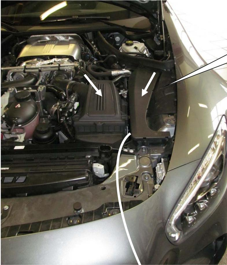
Abdeckung vom Kabelkanal und Luftfilterkasten beidseitig entfernen.
