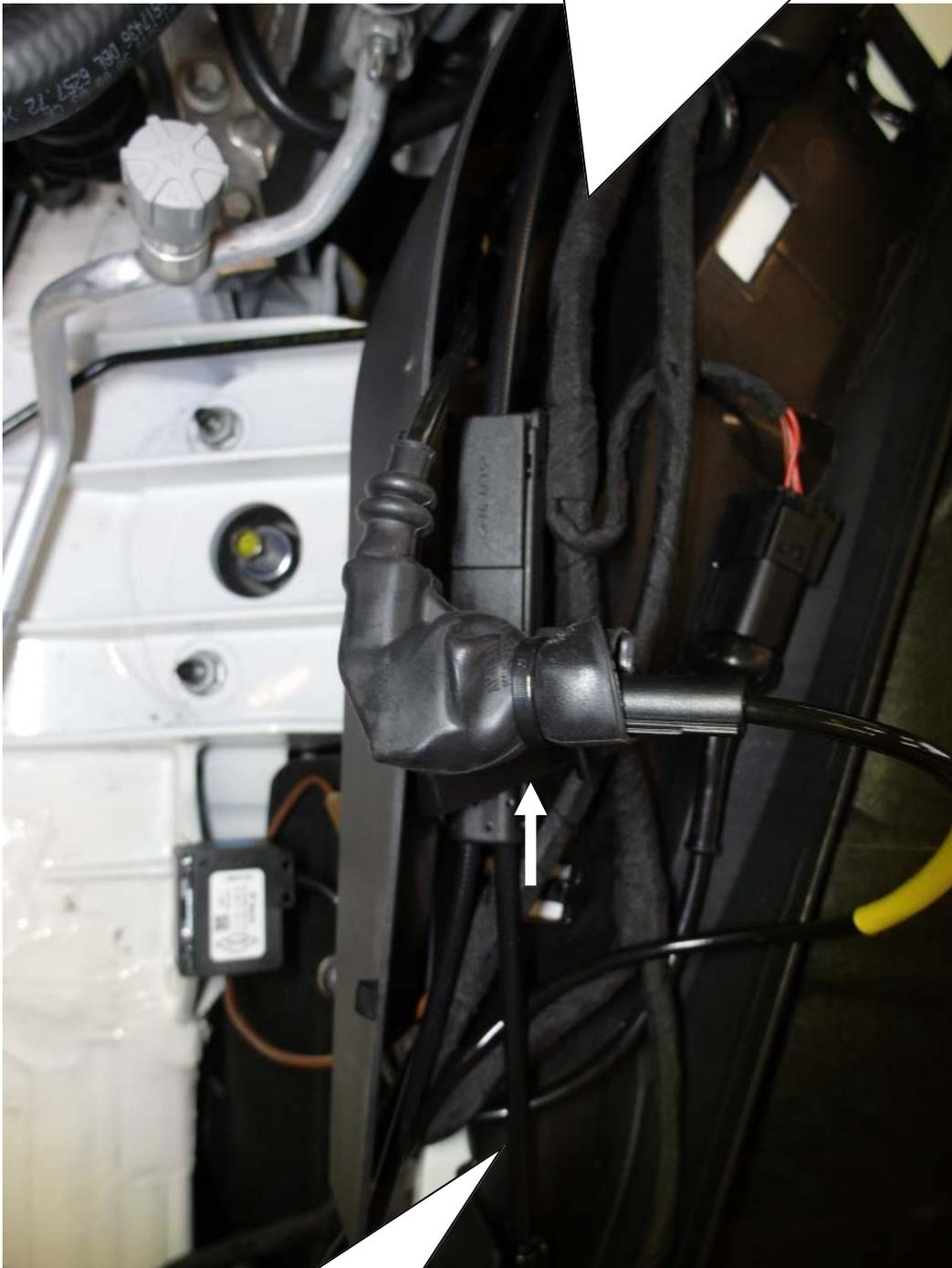
Leitung mit Kabelbindern am Kabelbaum sichern.
