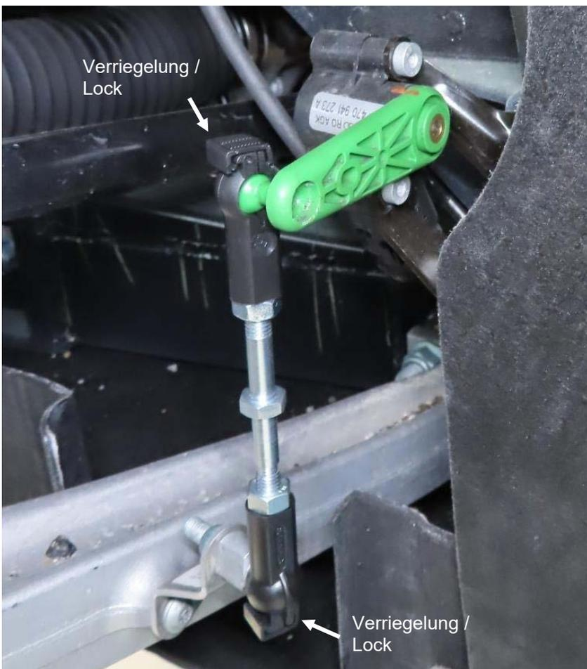
Mitgelieferte einstellbare Koppelstange montieren und verriegeln.
