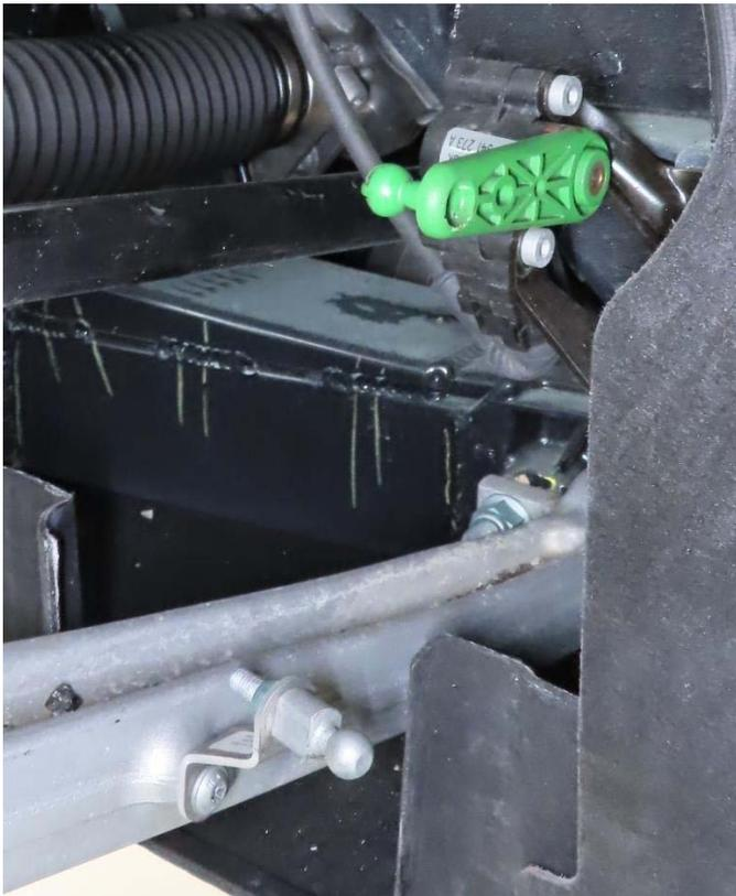
Koppelstange aus dem Querlenker und dem Sensor demontieren.
