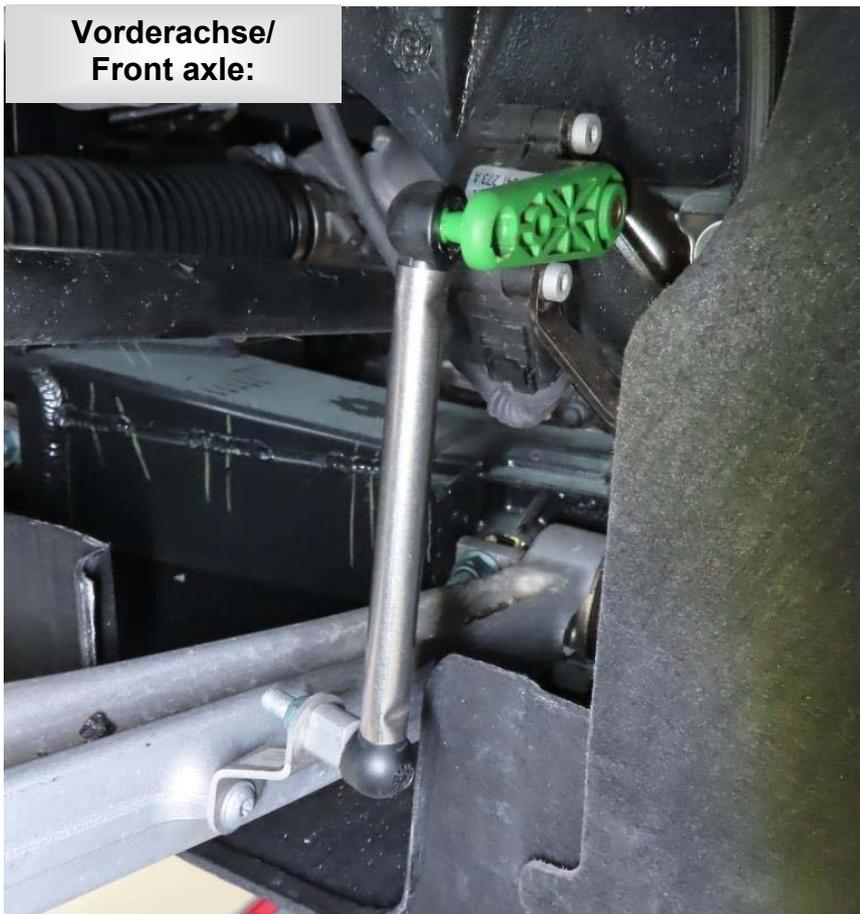
Hebelarmposition der VA Höhensensoren mit einem Stift (rechts und links) markieren.
