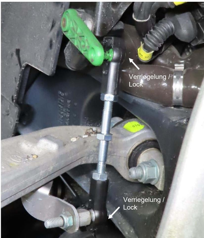
Mitgelieferte einstellbare Koppelstange montieren und verriegeln.
