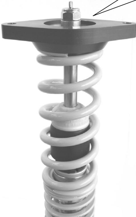
Original - Stützlager aufstecken und mit der mitgelieferten Stopmutter verschrauben. Die im Lieferumfang enthaltene Stützhülse wird, wie im Bild zu sehen, montiert. Das Anzugsdrehmoment der Kolbenstangenbefestigung beträgt 60 Nm. Die Montagehinweise zum Einbau des Federbeines in das Fahrzeug, sowie die Anzugsdrehmomente der Federbeinbefestigung, entnehmen Sie bitte den Unterlagen des Fahrzeugherstellers.
