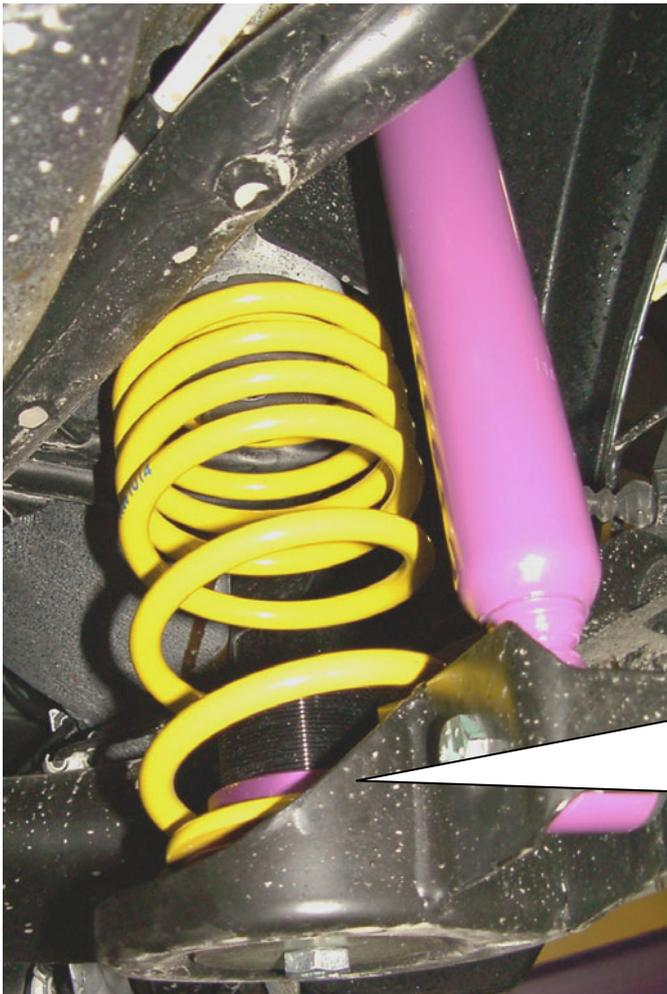
Federunterlage, welche serienmäßig in der Achse eingelegt ist, muss entfernt werden
