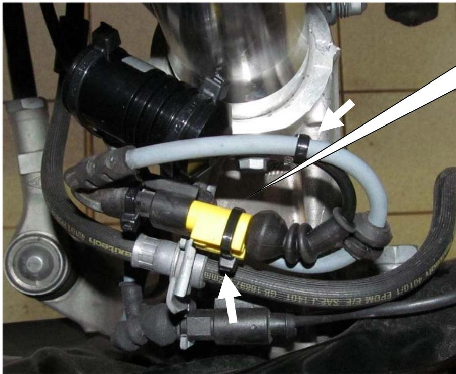
Leitung und Steckverbindung mit Kabelbindern am Halter befestigen.
