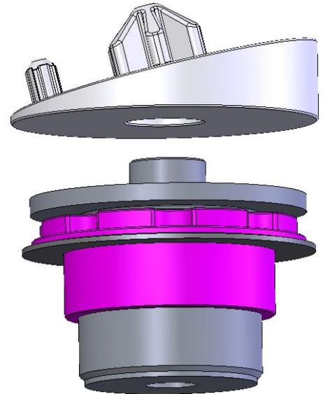
Die HA-Verstellung mit Adapter und Scheibe wird oben zwischen Feder und Karosserie montiert. Die serienmäßige Federunterlage entfällt. Zum Korrigieren (verdrehen des Gewinderings) der Fahrzeughöhe, ist die HA-Verstellung aus dem Fahrzeug zu demontieren.
