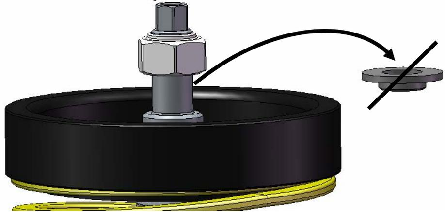
Mitgeliefertes Anschlagelament mit Staubschutzrohr in das Original Stützlager eindrücken.
