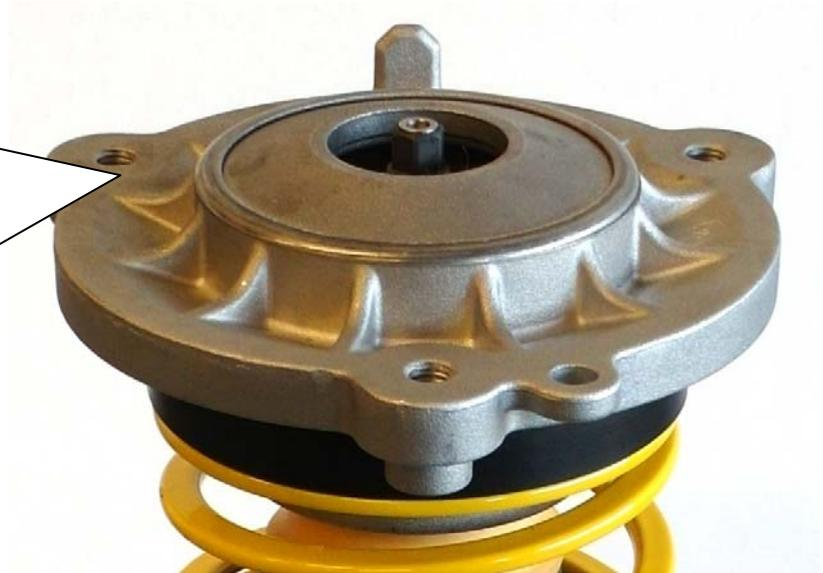
Original Abdeckung am Stützlager wieder montieren.
