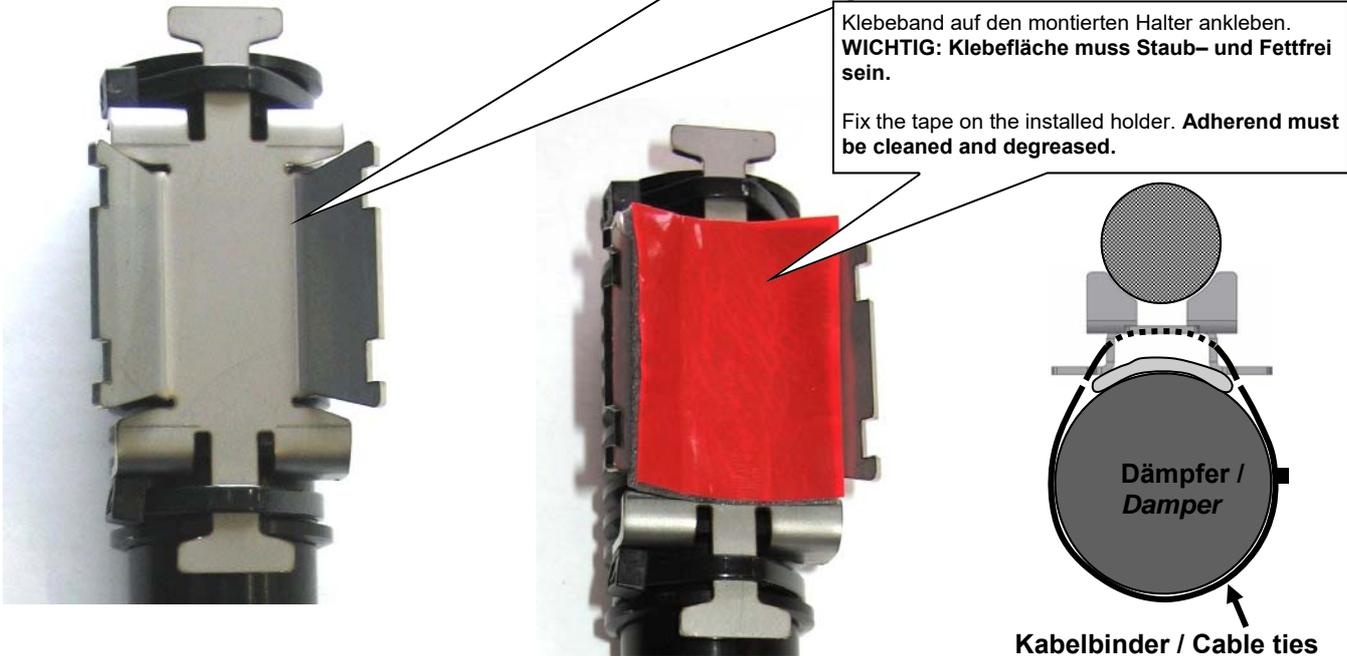
Stilllegung am Dämpfer mit dem Klebeband und Kabelbindern 4,8mm x 290mm befestigen.
