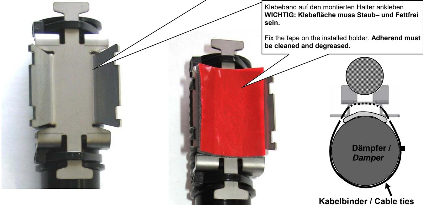
Klebeband auf den montierten Halter ankleben.
