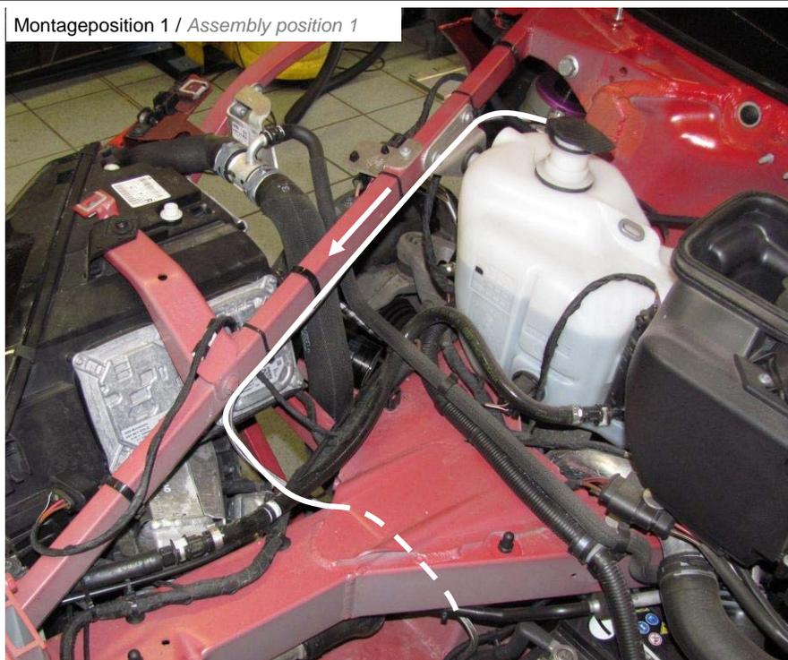
Hydraulikleitung nach unten verlegen und mit Kabelbinder befestigen. Kabelbinder erst nach vollständiger Leitungsverlegung festziehen
