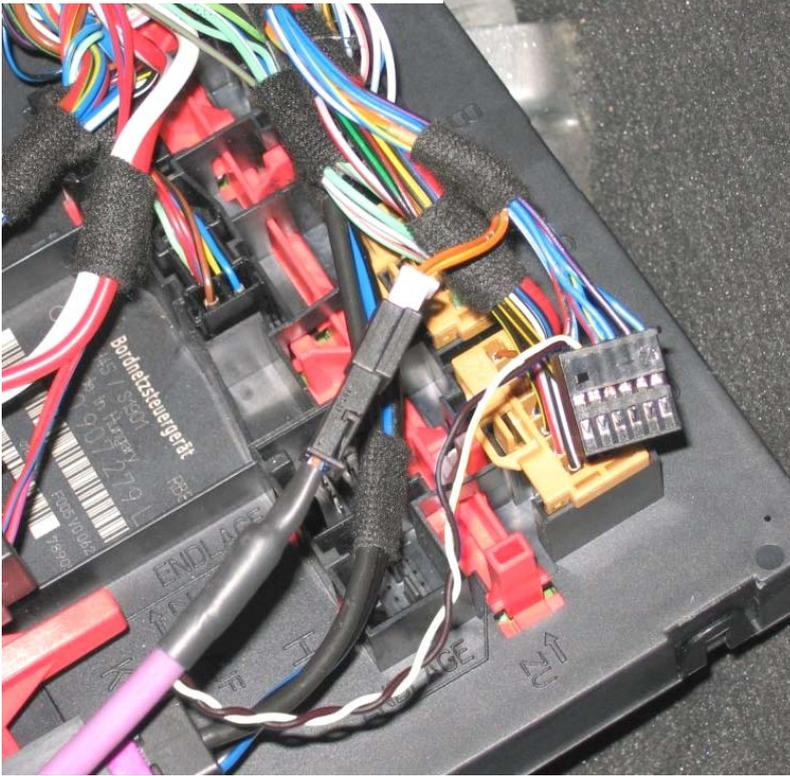
Anschließend die vom Y-Adapter abgehenden Kabel **Pin 1 (weiß)** und **Pin 2 (braun)** in den Originalstecker einstecken.
