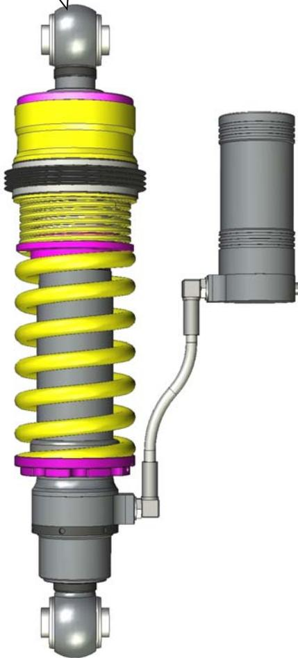
HLS Ringzylinder so positionieren, dass dieser mit der Hydraulikverschraubung zur Fahrzeugvorderseite zeigt.
