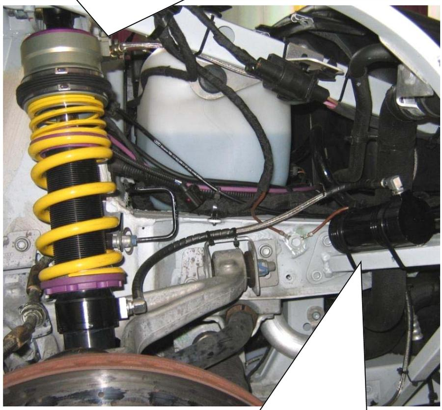
Druckausgleichsbehälter mit Kabelbinder am Fahrzeugrahmen befestigen. Hydraulikleitung mit Spiralschlauch umwickeln.
