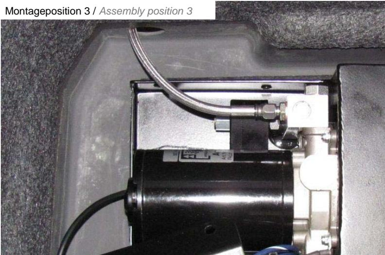
Anschließend Hydraulikleitung an dem zuvor montierten Adapter aufdrehen.
