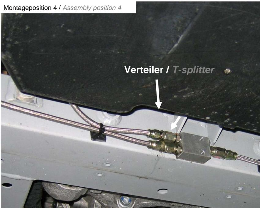
Hydraulikleitung (470 mm) mit dem Verteiler verbinden.
