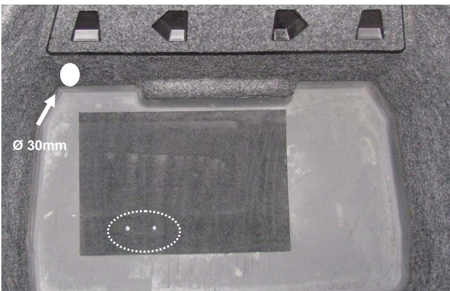
Halterung an der Bodenplatte mit den mitgelieferten Schrauben, Muttern und Scheiben montieren.
