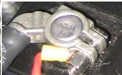
Masseleitung und Plusleitung an der Batterie anklammern.
