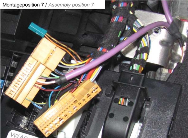
Anschließend die vom Y-Adapter abgehenden Kabel **Pin 1 (weiß)** und **Pin 2 (braun)** in den Originalstecker einstecken.
