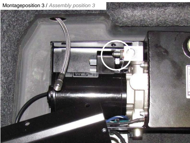
Mitgelieferten Anschlussadapter mit einer Dichtscheibe montieren.
