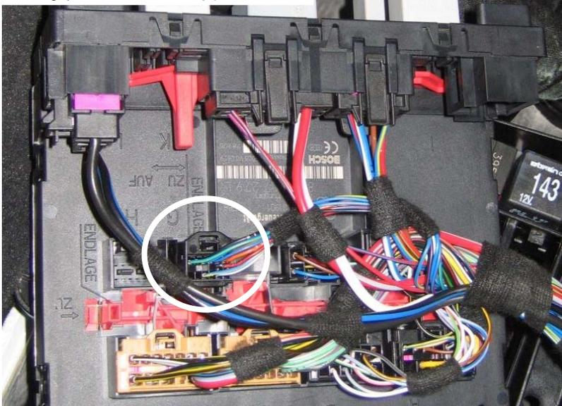
Markierter Steuergerätestecker G abziehen und Gehäuse vom Stecker entfernen.
