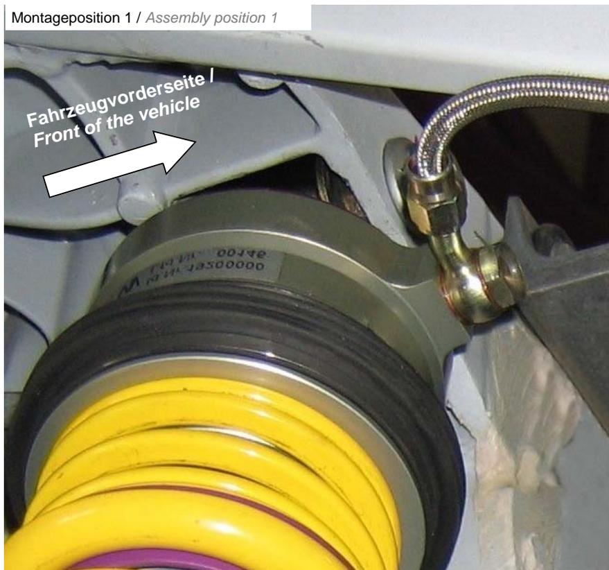
Hydraulikleitung (1340 mm) am HLS Ringzylinder mit der mitgelieferten Hohl-schraube und 2 Dicht-scheiben montieren. HLS Ringzylinder so positionieren, dass dieser mit der Hydraulikver-schraubung zur Fahrzeugvorder-seite zeigt.
