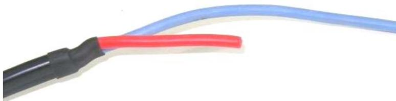
Aderabdichtung auf die Plusleitung aufstecken, Leitung 6 mm abisolieren und Kontakt mit einem geeignetem Werkzeug montieren.
