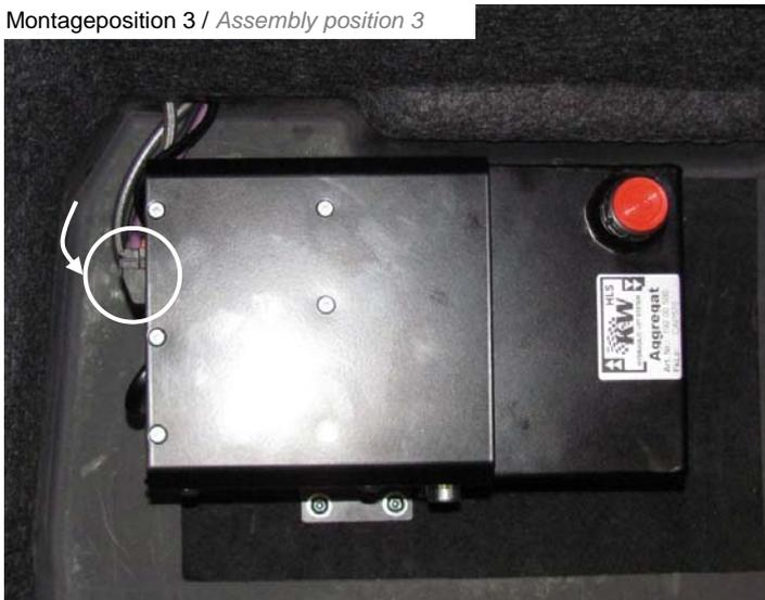
Mitgelieferte CAN Leitung in das HLS Steuergerät einstecken und Stecker verriegeln. CAN Leitung durch die Serienmäßige Kabeldurchführung in den Fahrzeuginnenraum verlegen.
