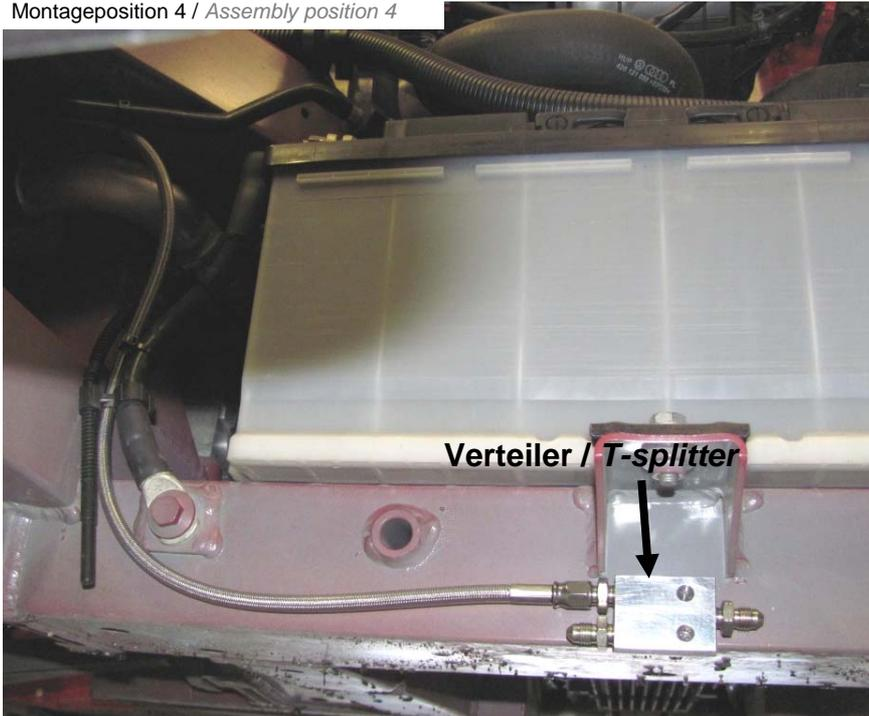
Hydraulikleitung (1340 mm) mit dem Verteiler verbinden. Anschließend Hydraulikleitung mit den mitgelieferten Klebesockeln am Fahrzeugrahmen befestigen. Kabelbinder erst nach vollständiger Leitungsverlegung festziehen.
