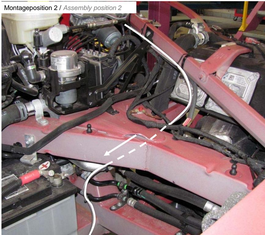
Hydraulikleitung nach unten verlegen und mit Kabelbinder befestigen. Kabelbinder erst nach vollständiger Leitungsverlegung festziehen
