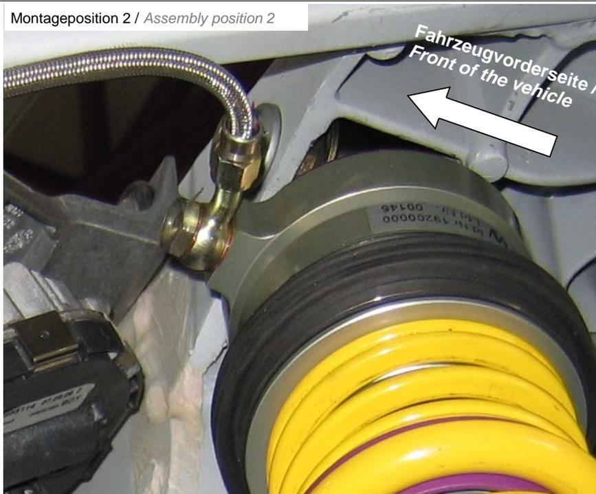
Hydraulikleitung (1340 mm) am HLS Ringzylinder mit der mitgelieferten Hohlschraube und 2 Dichtscheiben montieren.
