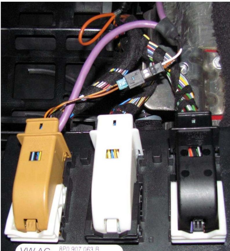
Steckergehäuse wieder anbringen und Stecker in das Steuergerät einstecken.
