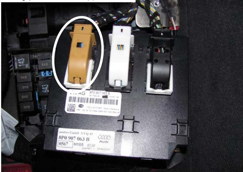
Markierter Steuergerätestecker (Farbe braun) abziehen und Gehäuse vom Stecker entfernen.
