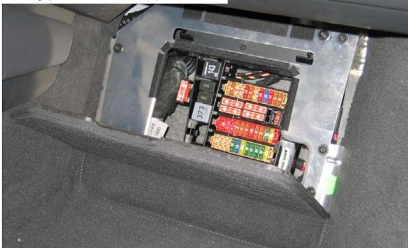
Abdeckung des Fahrzeugsteuergeräts entfernen. Das Fahrzeugsteuergerät befindet sich im Fußraum rechte Fahrzeugseite.
