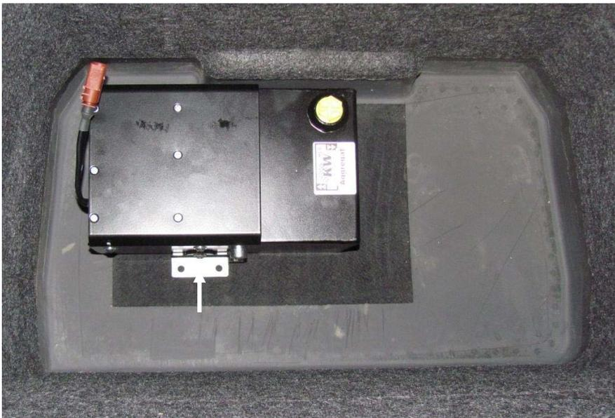
Bohrungen an der Bodenplatte markieren und mit  $\varnothing 6,5$  mm durchbohren.
