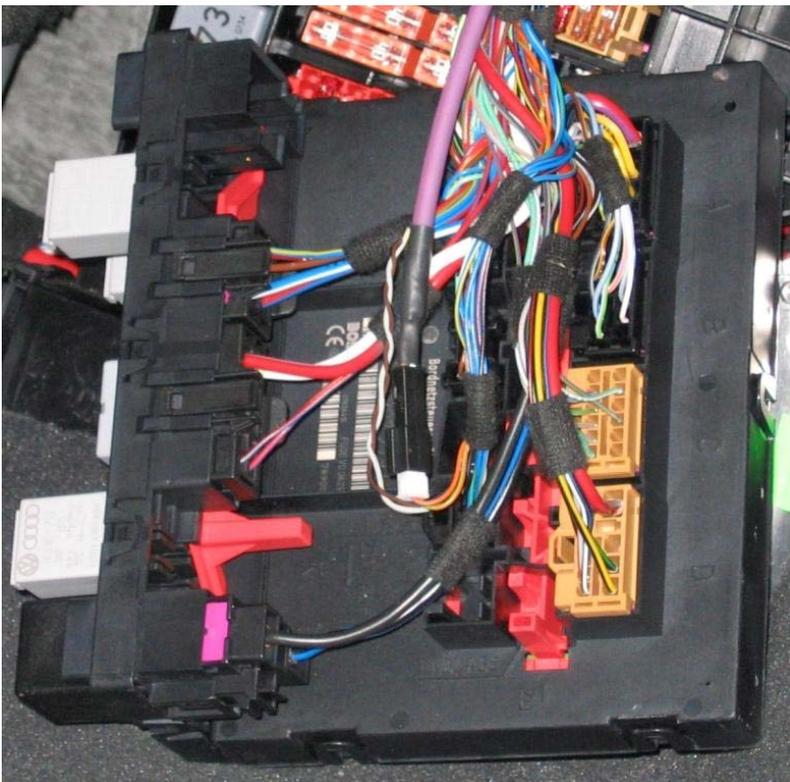
Steckergehäuse wieder anbringen und Stecker in das Steuergerät einstecken.
