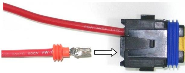
Fertig montierte Plusleitung in den Sicherungshalter einrasten.
