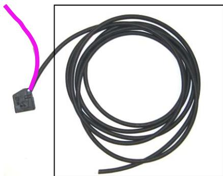
Tasterleitung durch den Innenraum an der linken Fahrzeugseite nach vorne verlegen.
