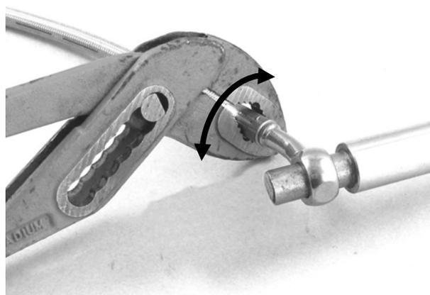
*Der Anschluss der Hydraulikleitung kann mit einer Zange und einem Rundmaterial gedreht werden.*
