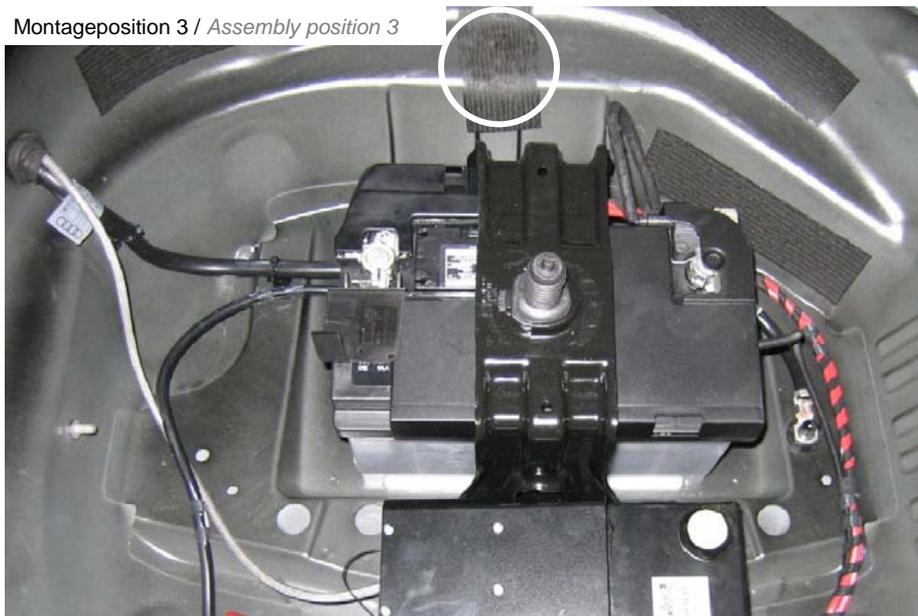
Für die Leitungsverlegung des muss mittig ein Loch mit  $\varnothing$  30 mm in die Ersatzradmulde gebohrt werden.
