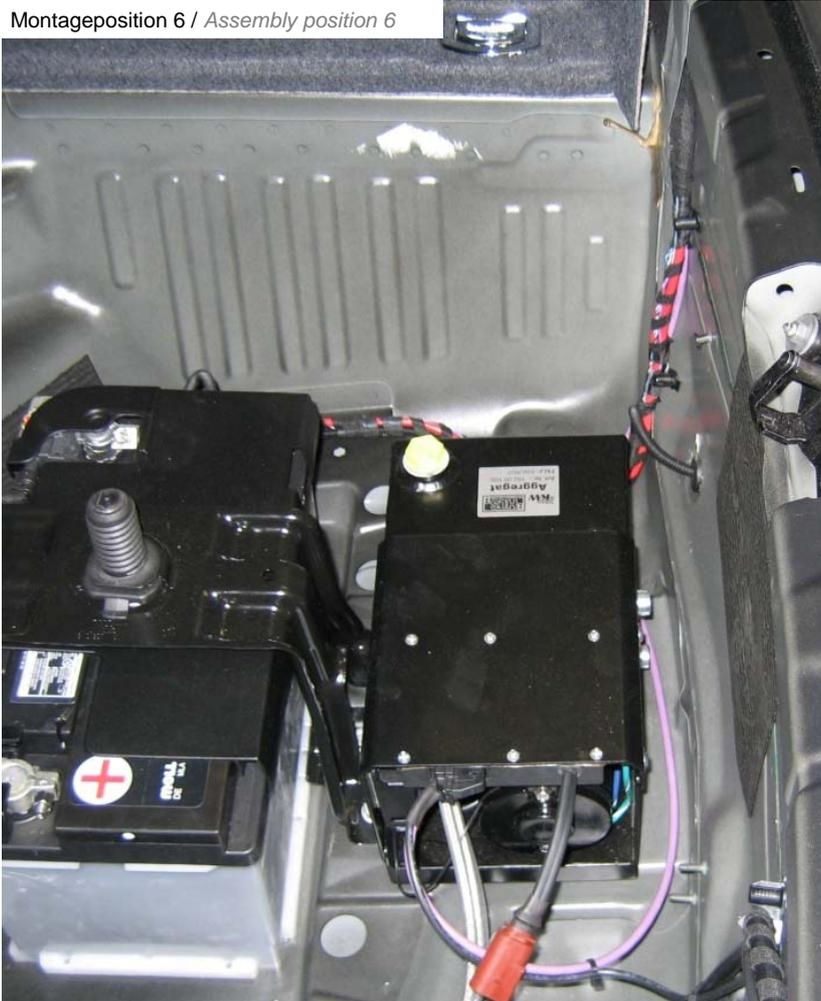
CAN Leitung entlang dem Kabelbaum zum Hydraulikaggregat verlegen und in das Steuergerät einstecken und verriegeln.
