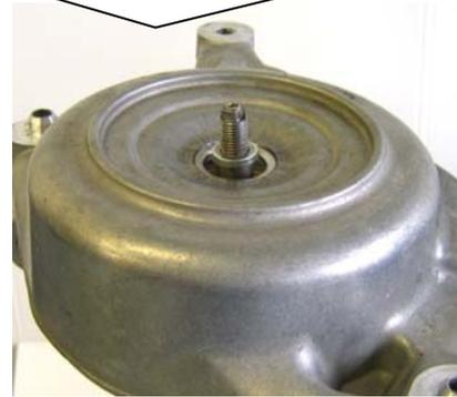
HLS Ringzylinder so positionieren, dass dieser mit der Hydraulikverschraubung zur Fahrzeugheckseite innen zeigt.
