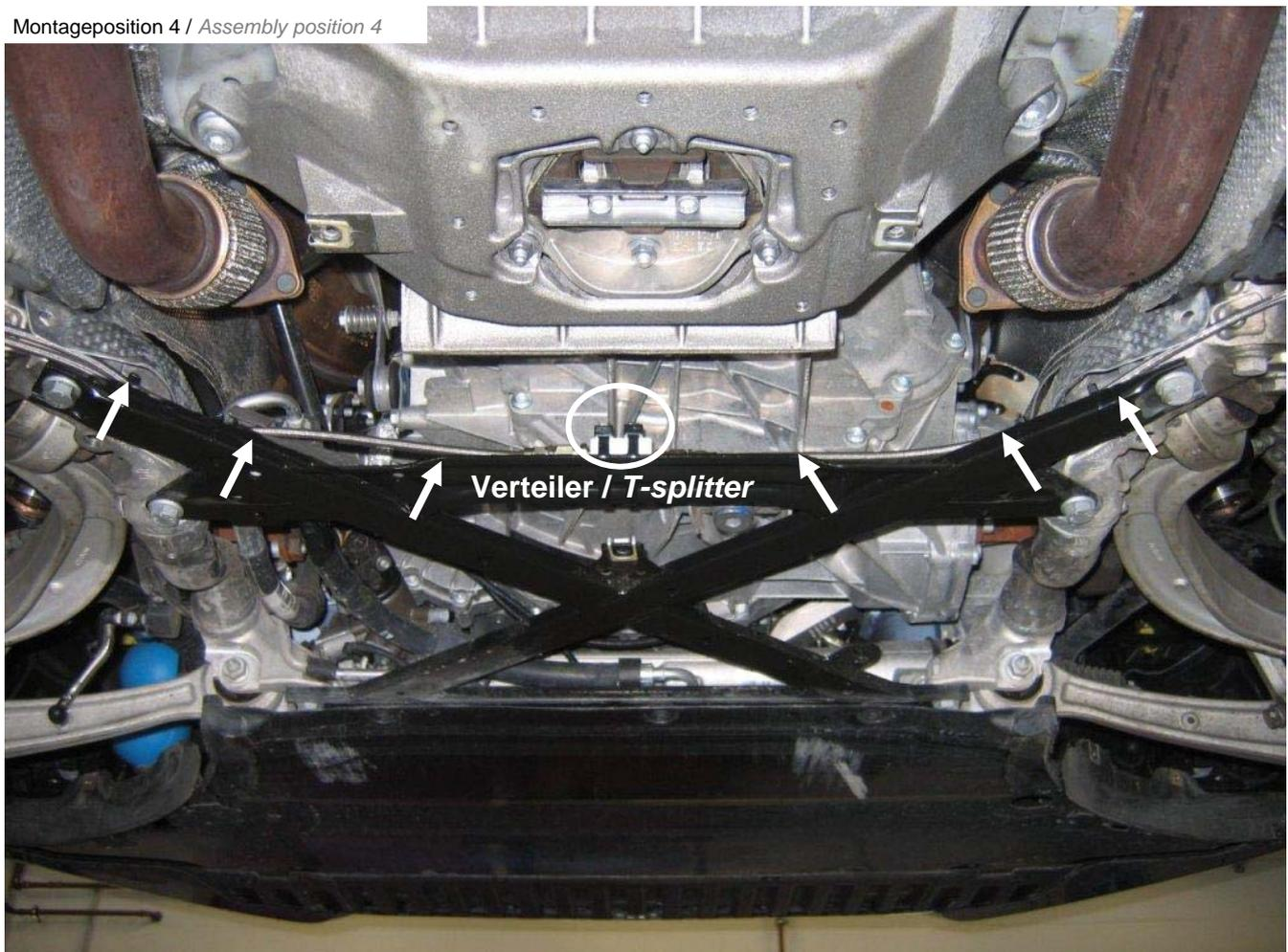
Hydraulikleitungen (4300 mm) mit dem Verteiler verbinden. Anschließend Hydraulikleitung mit den mitgelieferten Kabelbinder an den Streben und an der Batterieleitung befestigen. Kabelbinder erst nach vollständiger Leitungsverlegung festziehen.
