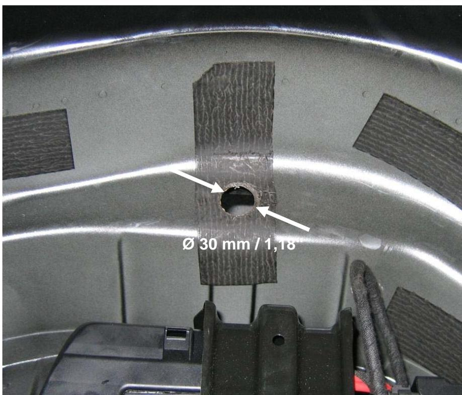
Mitgelieferter Verschlussstopfen an der Markierung einschneiden und in die Öffnung eindrücken. Nach der Leitungsverlegung sollte die Öffnung mit Karosseriekleber abgedichtet werden.
