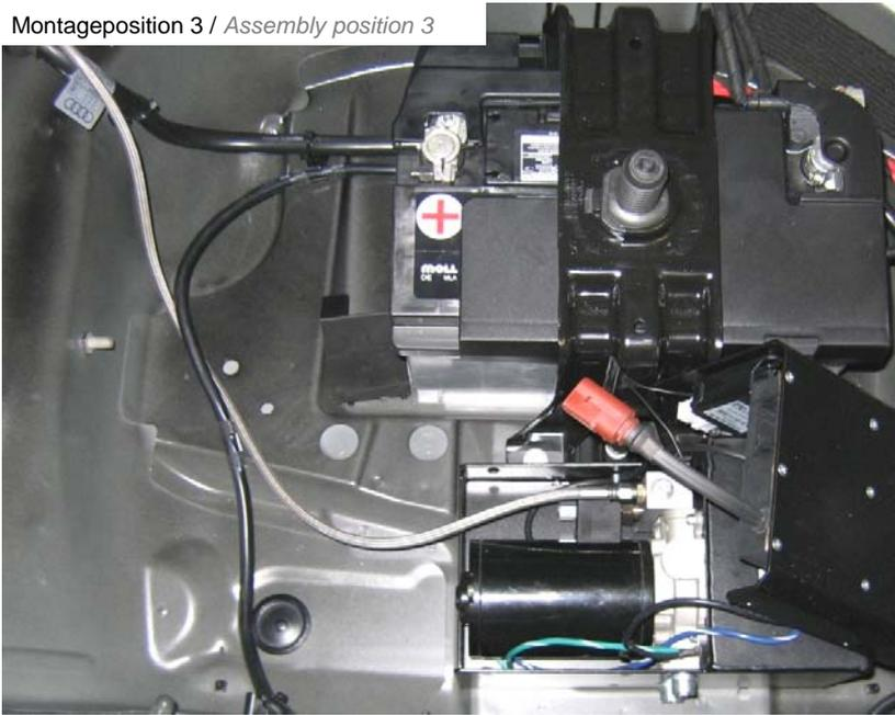
Hydraulikleitung durch die serienmäßige Öffnung entlang der Batterieleitung verlegen und mit Kabelbinder befestigen.
