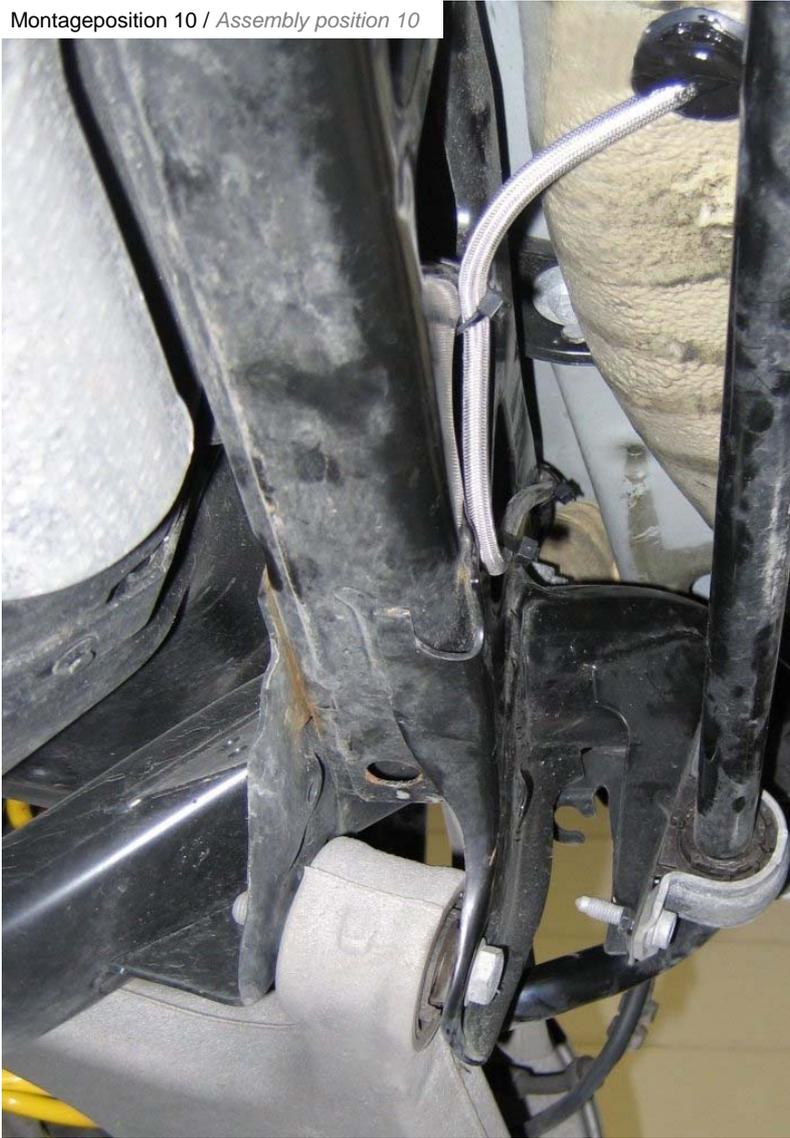
Hydraulikleitung an der Hinterachse mit Kabelbinder befestigen und durch die neue Öffnung in den Fahrzeuginnenraum verlegen.
