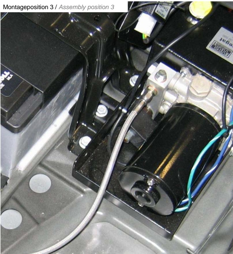
Absperrstopfen herausdrehen. Mitgelieferten Anschlussadapter mit einer Dichtscheibe montieren. Anschließend Hydraulikleitung an dem zuvor montierten Adapter aufdrehen.
