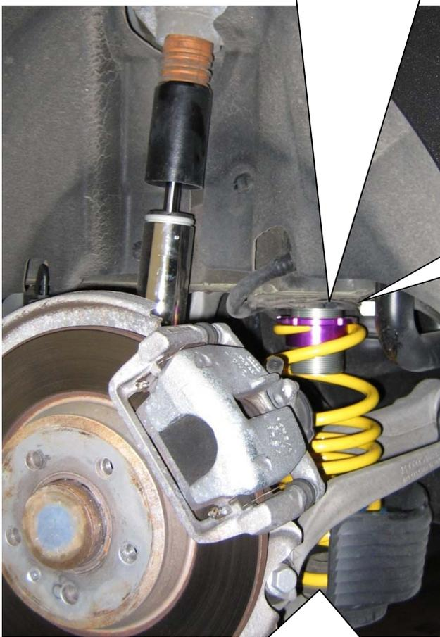
**Der Anschluss des Ringzylinders muss in Richtung Fahrzeugvorderseite zeigen.**
