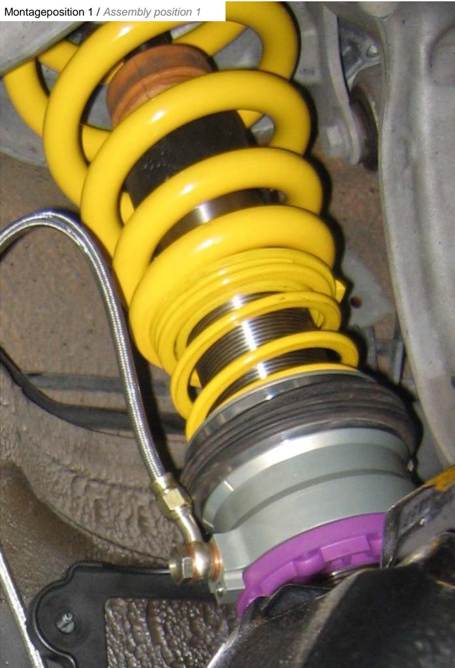
Hydraulikleitung (1340 mm) am HLS Ringzylinder mit der mitgelieferten Hohlschraube und 2 Dichtscheiben montieren.
