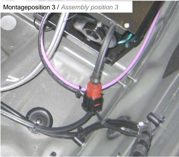
Spannungsversorgungsleitung mit dem Hydraulikaggregat verbinden und auf entsprechende Länge kürzen.
