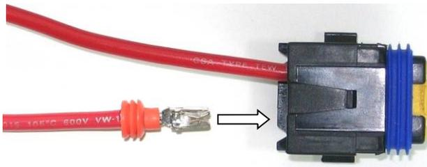
Fertig montierte Plusleitung in den Sicherungshalter einrasten.
