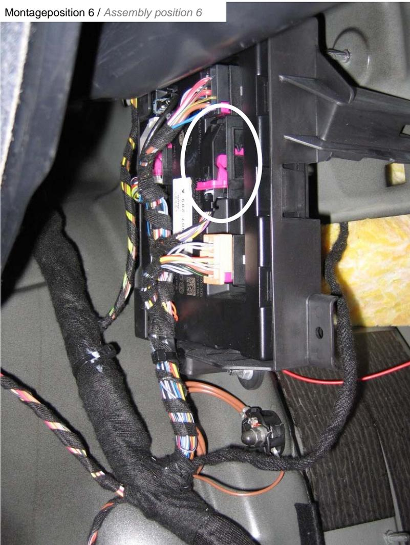
Markierter Steuergerätestecker abziehen und Gehäuse vom Stecker entfernen.
