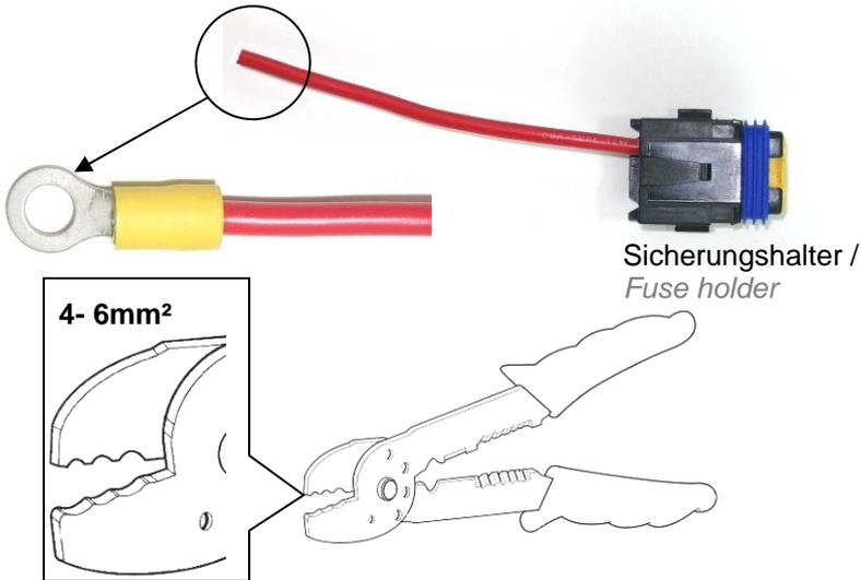
Plusleitung (rot) 8 mm abisolieren und mitgelieferten Kabelschuh mit geeignetem Werkzeug montieren.
