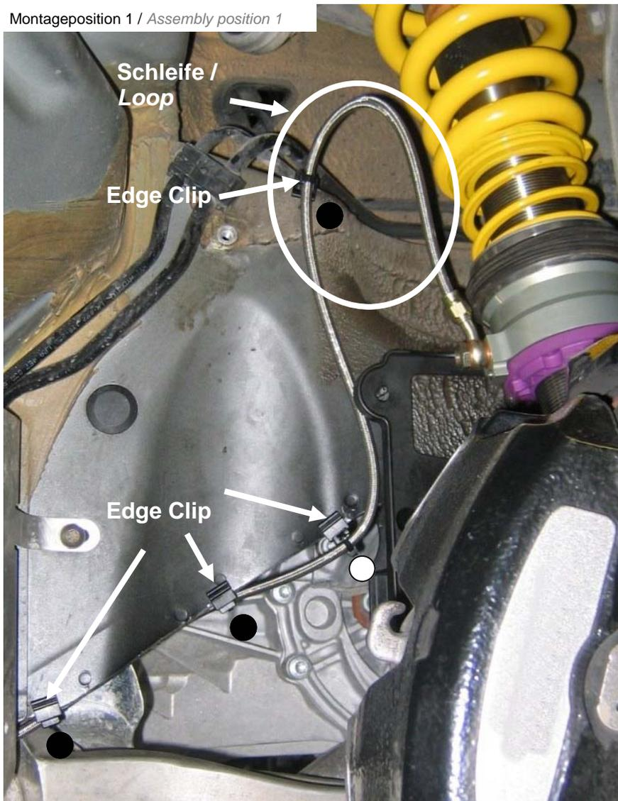
Hydraulikleitung mit Befestigungsbinder Edge Clips entlang der Karosseriekannte verlegen. Kabelbinder erst nach vollständiger Leitungsverlegung festziehen
