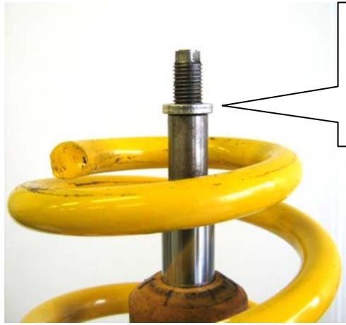
Die originale Stützscheibe wird, wie im Bild dargestellt, auf die Kolbenstange aufgesteckt.
