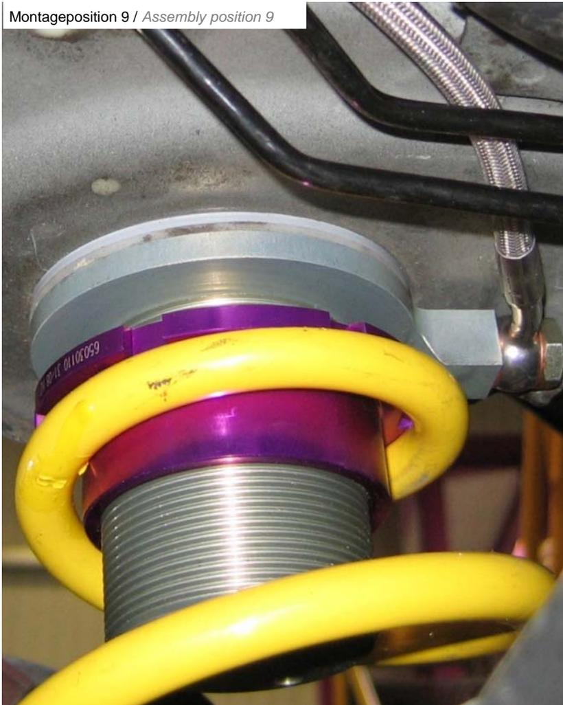
Hydraulikleitung (1850 mm) am HLS Ringzylinder mit der mitgelieferten Hohl-schraube und 2 Dichtscheiben montieren. HLS Ringzylinder so positionieren, dass dieser mit der Hydraulikverschraubung schräg zur Fahrzeugvorderseite innen zeigt.
