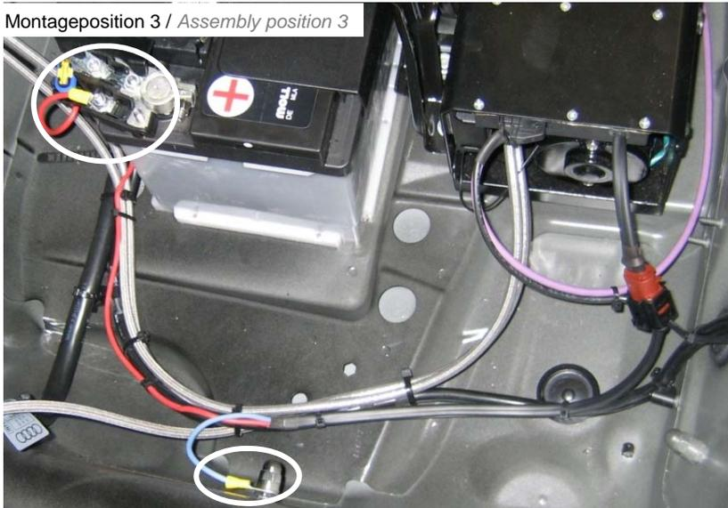
Plusleitung an der Batterie anklemmen und Masseleitung an der Fahrzeugkarosserie anklemmen.
