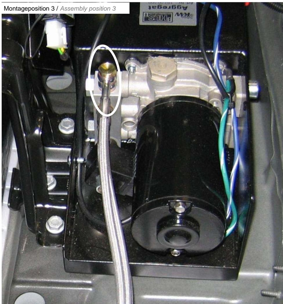
Hydraulikleitungen am Hydraulikaggregat mit der mitgelieferten doppelten Hohl- schraube und 3 Dichtscheiben montieren.
