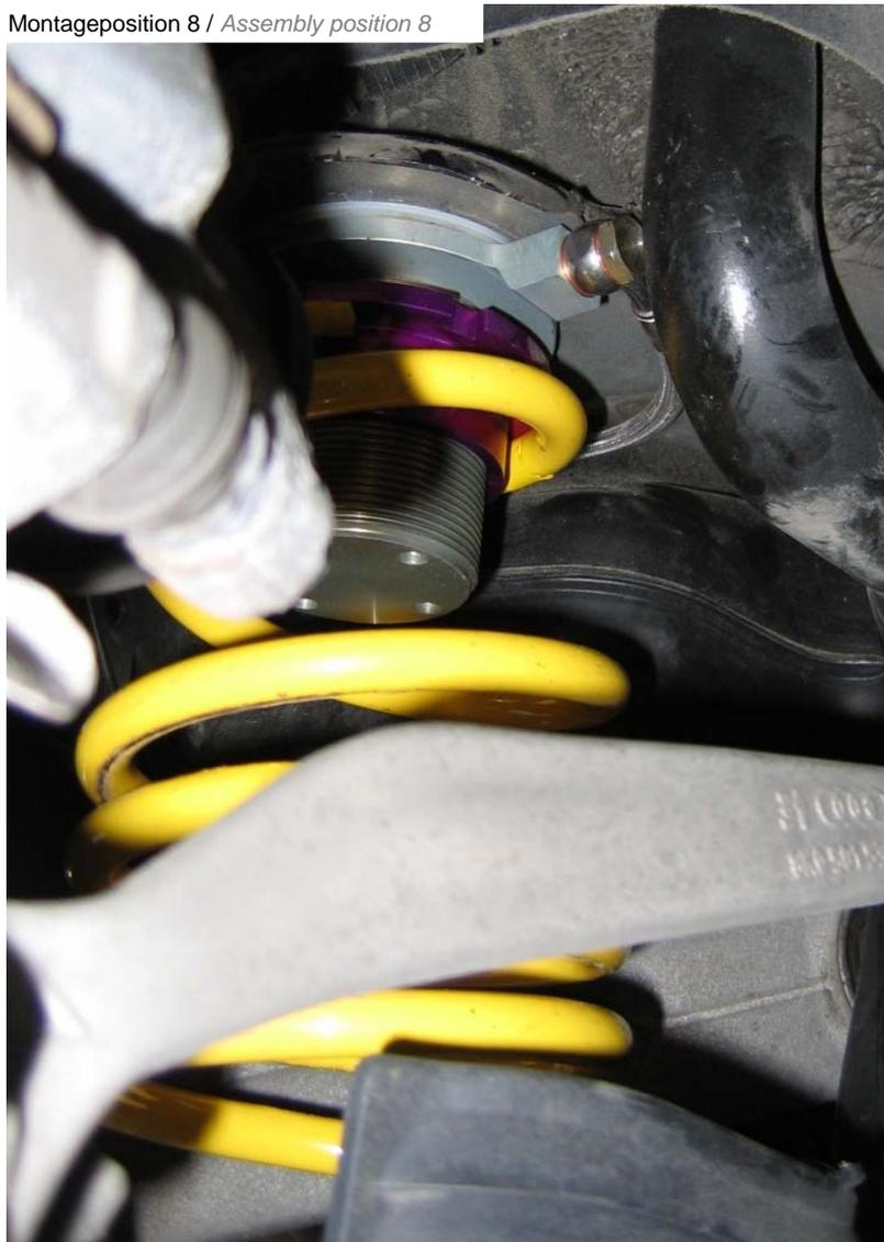
Hydraulikleitung (1850 mm) am HLS Ringzylinder mit der mitgelieferten Hohl-schraube und 2 Dichtscheiben montieren. HLS Ringzylinder so positionieren, dass dieser mit der Hydraulikverschraubung schräg zur Fahrzeugvorderseite innen zeigt.
