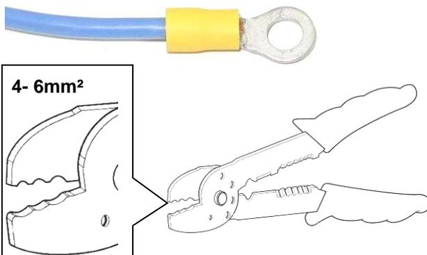
Masseleitung (blau) 8 mm abisolieren und mitgelieferten Kabelschuh mit geeignetem Werkzeug an der Masseleitung (blau) montieren.
