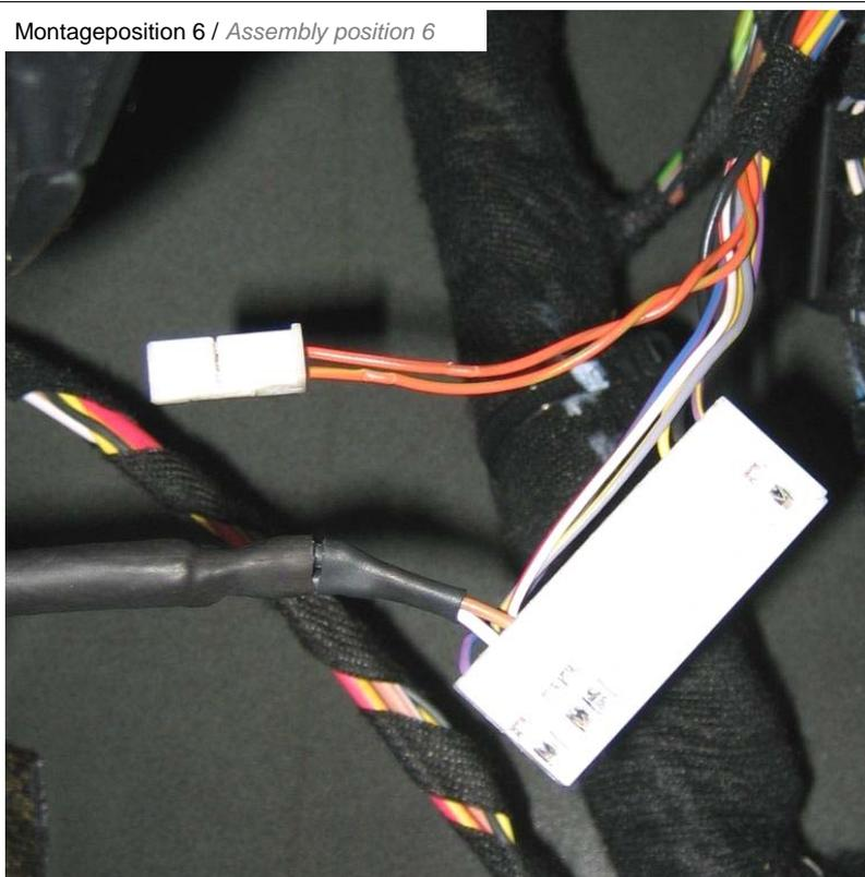
Anschließend die vom Y-Adapter abgehenden Kabel in den Originalstecker einstecken.
