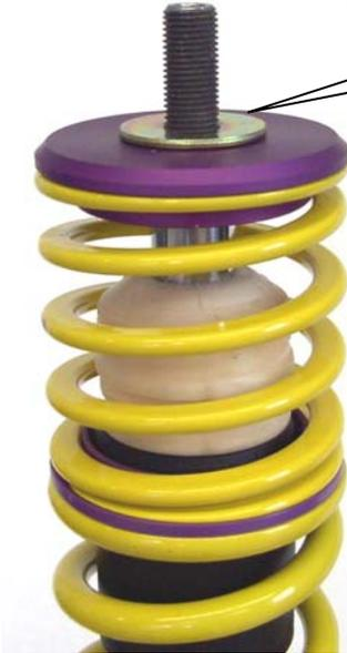
Serienstützlager aufsetzen und mit der mitgelieferten Stoppmutter verschrauben. Anzugsdrehmoment 50 Nm. Die Montagehinweise zum Einbau des Federbeines in das Fahrzeug, sowie die Anzugsdrehmomente der Federbeinbefestigung, entnehmen Sie bitte den Unterlagen des Fahrzeugherstellers.
