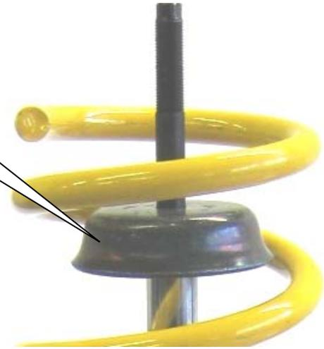
Original Stützlager aufsetzen und mit den mitgelieferten Muttern verschrauben. Die Montagehinweise zum Einbau des Federbeines in das Fahrzeug, sowie die Anzugsdrehmomente der Federbeinbefestigung, entnehmen Sie bitte den Unterlagen des Fahrzeugherstellers.
