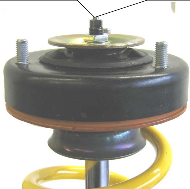
Bei Fahrzeugen mit EDC (Kolbenstangenbefestigung M12 Gewinde anstatt M10) müssen folgende Stützlager Teile verwendet werden. Bei Kolbenstangenbefestigung M12: Anzugsdrehmoment 35 Nm. Bei Kolbenstangenbefestigung M10 Anzugsdrehmoment 25 Nm.
