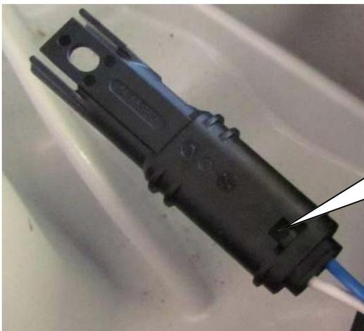
2. Steckersicherung öffnen. Original Dämpferleitung mit geeignetem Werkzeug aus dem Stecker ausspinnen.
