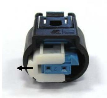
2. Original Leitung in die mitgelieferte Buchse mit Abdichtungen ganz einschieben und einrasten. Pinposition / Kabelfarbe ist nicht relevant. Anschließend Steckergehäuse verriegeln.
