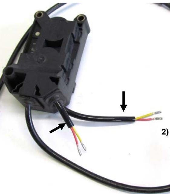
2. 15 mm von der Ummantelung der Leitung entfernen und die Adern 4 - 5 mm abisolieren.
