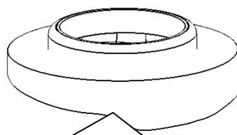
Am unteren Ende der Feder wird der mitgelieferten Adapterring eingesetzt.
