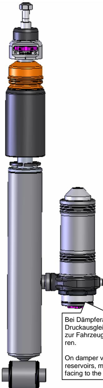
Die HA-Verstellung wird oben zwischen Feder und Karosserie montiert. Die serienmäßige Federunterlage entfällt. Zum Korrigieren (verdrehen des Gewinderings) der Fahrzeughöhe, ist die HA-Verstellung aus dem Fahrzeug zu demontieren.
