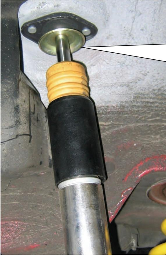
Original Stützscheibe mit Domlager aufstecken. Das Anzugsdrehmoment der Kolbenstangenbefestigung beträgt 25 Nm. Die Montagehinweise zum Einbau des Federbeines in das Fahrzeug, sowie die Anzugsdrehmomente der Federbeinbefestigung, entnehmen Sie bitte den Unterlagen des Fahrzeugherstellers.
