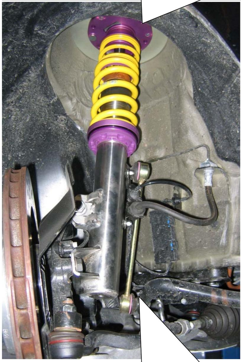
Die Original Pendelstütze muss durch die mitgelieferte ausgetauscht werden.
