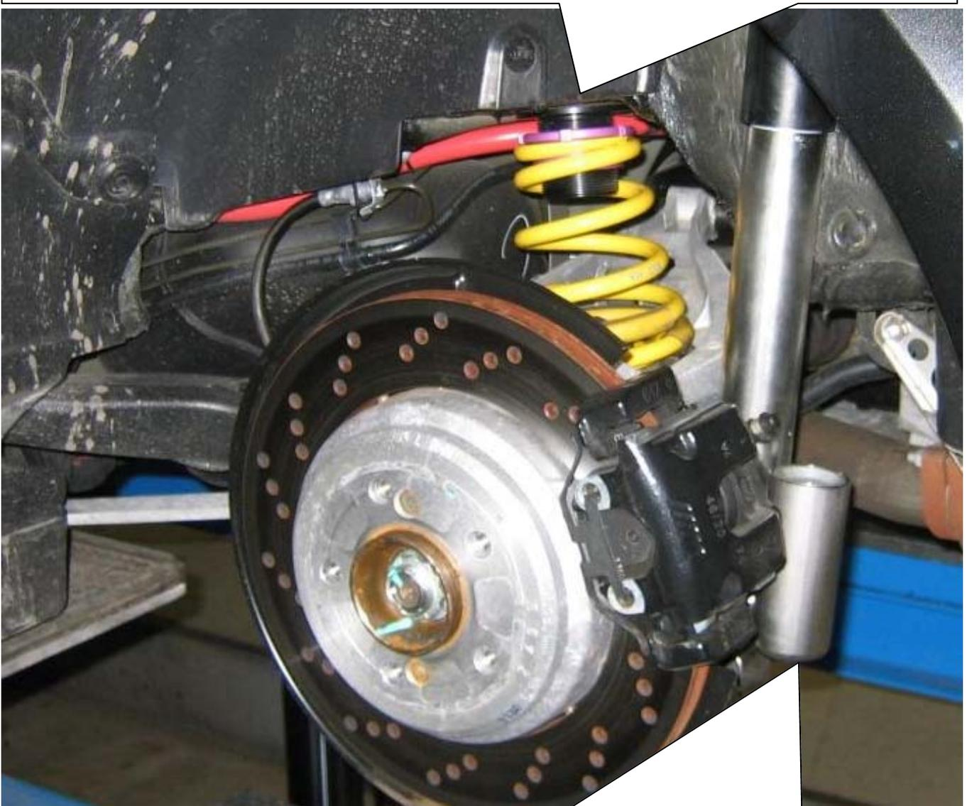
Bei Dämpferausführungen mit Druckausgleichsbehälter ist dieser, wie auf dem Bild zu sehen, nach hinten zu montieren.
