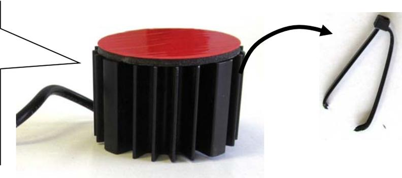
Originale Dämpfersteuerungsleitung in die mitgelieferten Stilllegung einstecken. Auf die korrekte Verriegelung des Steckers achten! Stilllegung mit dem mitgelieferten Klebe pad an der Fahrzeugkarosserie befestigen.
