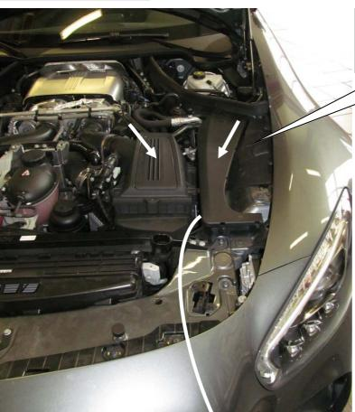
Abdeckung vom Kabelkanal und Luftfilterkasten beidseitig entfernen.
