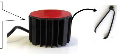
Originale Dämpfersteuerungsleitung in die mitgelieferte Stilllegung einstecken. Auf die korrekte Verriegelung des Steckers achten! Stilllegung mit dem Klebepad an der Fahrzeugkarosserie befestigen.
