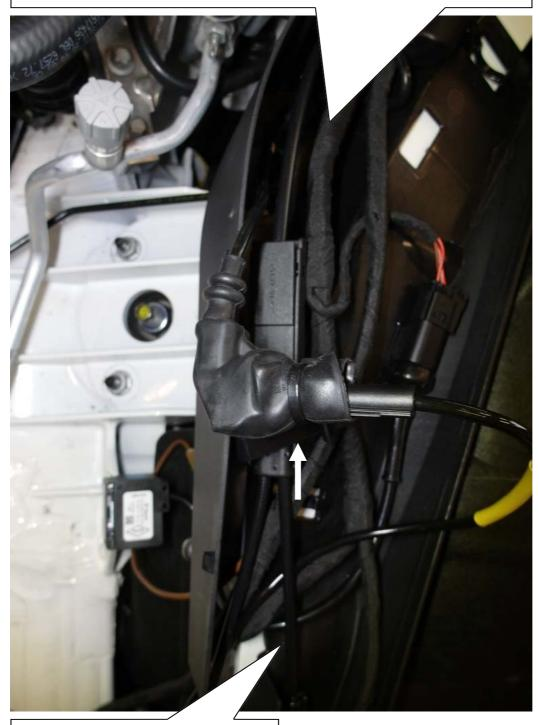
Leitung mit Kabelbindern am Kabelbaum sichern.
