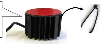
Originale Dämpfersteuerungsleitung in die mitgelieferte Stilllegung einstecken. Auf die korrekte Verriegelung des Steckers achten! Stilllegung mit dem Klebepad an der Fahrzeugkarosserie befestigen.
