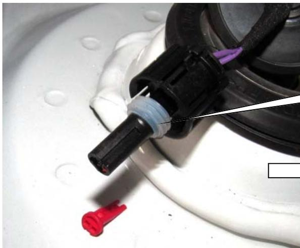
2. Rote Steckersicherung aus dem Stecker herausziehen. Original Dämpferleitung mit geeignetem Werkzeug aus der Stecker ausspinnen.
