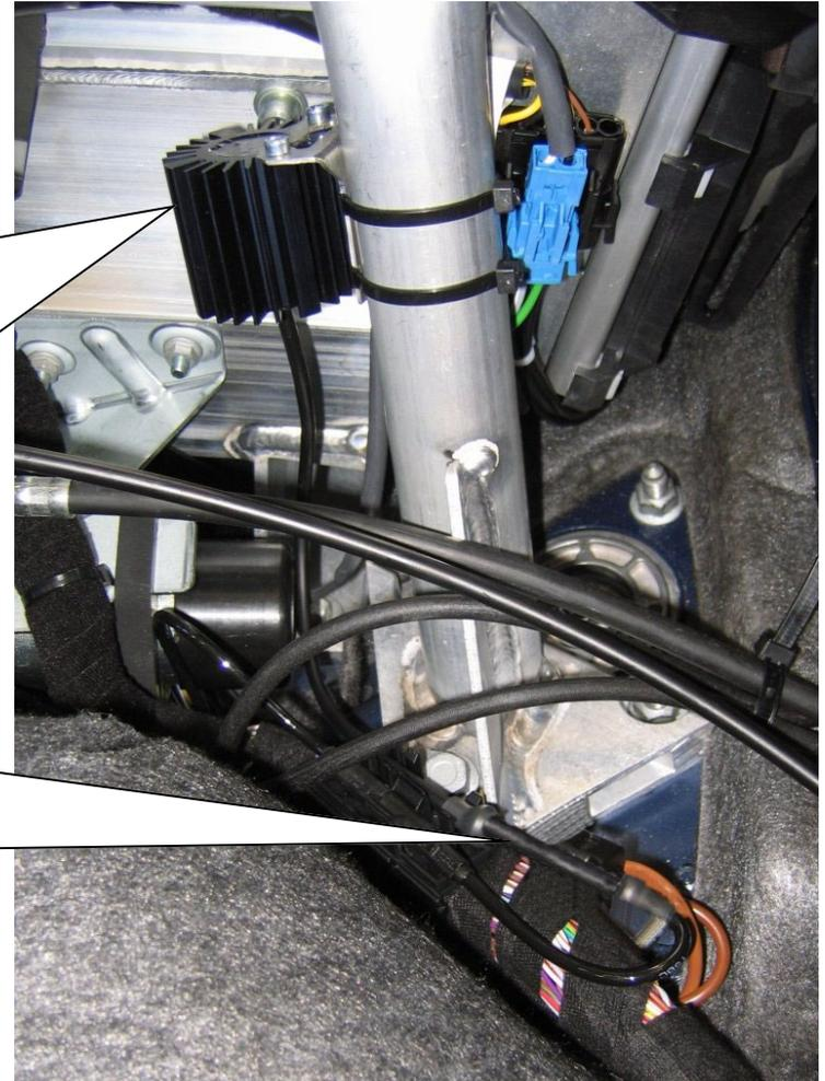
Originale Dämpfersteuerungsleitung in die mitgelieferten Stilllegungen einstecken. Auf die korrekte Verriegelung des Steckers achten! Anschließend originale Dämpfersteuerungsleitung mit Kabelbinder befestigen und die Abdeckung wieder montieren.
