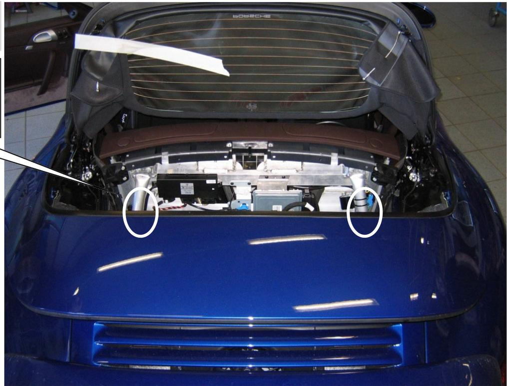
Stilllegungen und Halterung mit den mitgelieferten Kabelbinder am Fahrzeug montieren.
