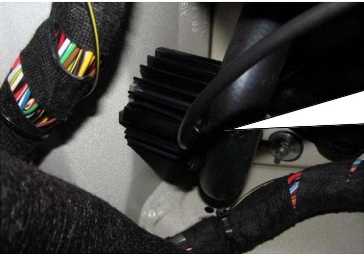
Stilllegungen auf den Fahrzeugrahmen kleben. Originale Dämpfersteuerungsleitung in die Stilllegungen einstecken. Auf die korrekte Verriegelung des Steckers achten!
