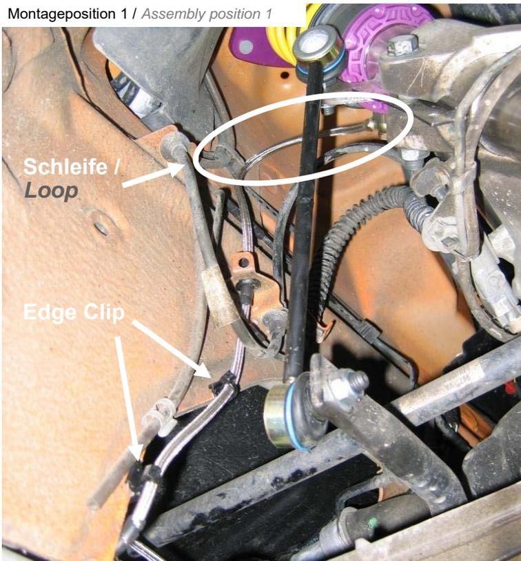
Hydraulikleitung mit Befestigungsbinder Edge Clips entlang der Karosseriekannte verlegen. Kabelbinder erst nach vollständiger Leitungsverlegung festziehen
