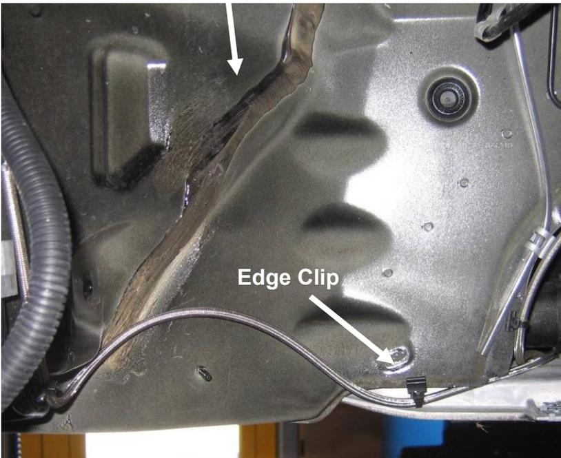
Hydraulikleitung entlang der Klimaleitung verlegen und mit Kabelbinder befestigen.
