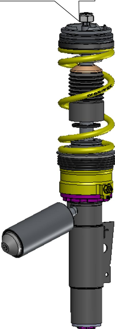
**Der Anschluss des Ringzylinders muss in Richtung Fahrzeugvorderseite innen zeigen.**
