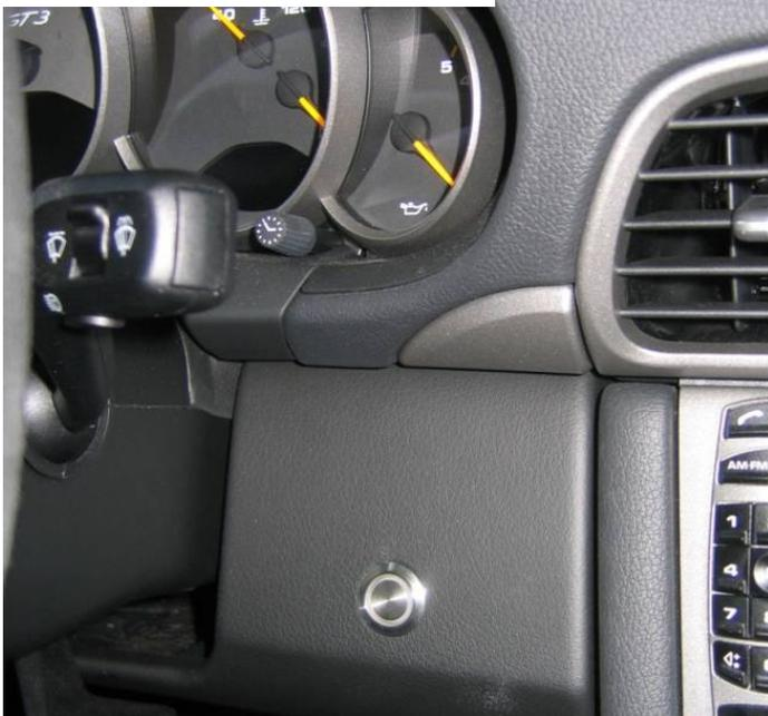
Für die Montage des Tasters muss ein Loch in das Armaturenbrett gebohrt werden.
