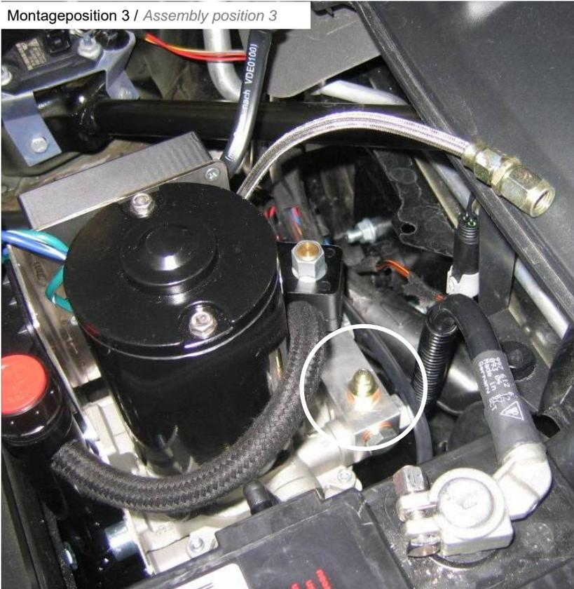
Mitgelieferten Anschlussadapter mit einer Dichtscheibe montieren.
