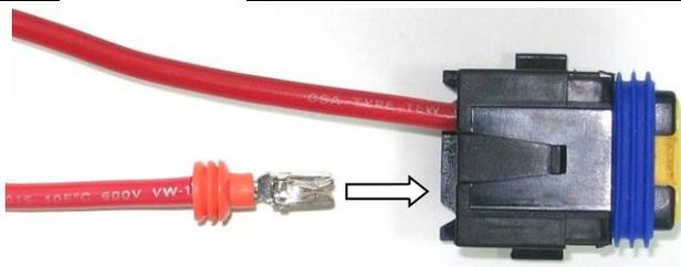
Fertig montierte Plusleitung in den Sicherungshalter einrasten.
