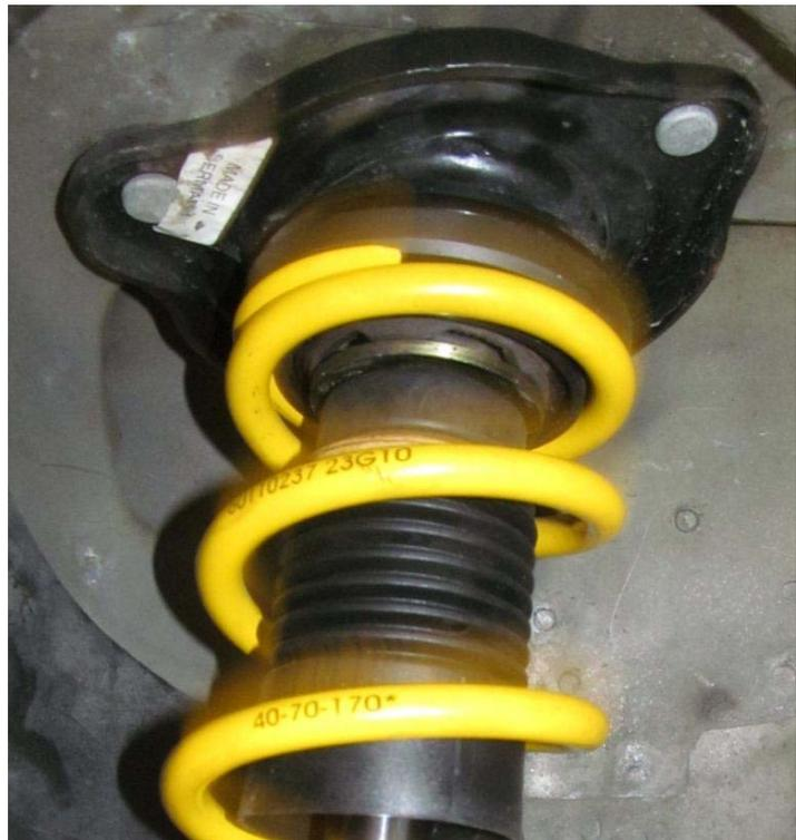
Das Federbein muss so positioniert werden, dass der Dämpferausgleichsbehälter, wie im Bild zu sehen, oberhalb des Achsschenkels liegt und nach hinten zeigt. Bild zeigt die rechte Einbauseite. Die mitgelieferte Stabilisatorpendelstütze wird wie in der Serie montiert.
