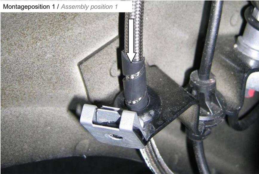
Mitgelieferte Gummitülle in den am Fahrzeug freien Halter eindrücken und Hydraulikleitung von oben durchfädeln.
