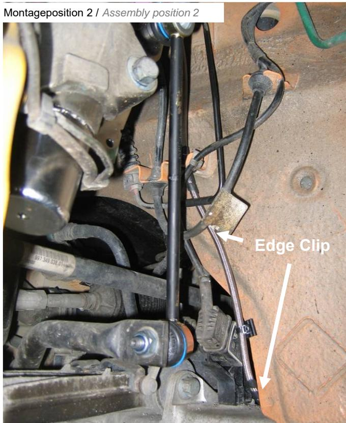
Hydraulikleitung mit Befestigungsbinder Edge Clips entlang der Karosseriekannte verlegen. Kabelbinder erst nach vollständiger Leitungsverlegung festziehen
