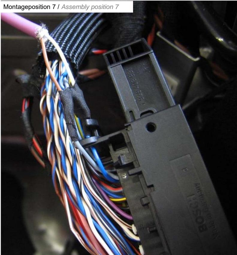
Lötstelle mit Klebeband isolieren.
