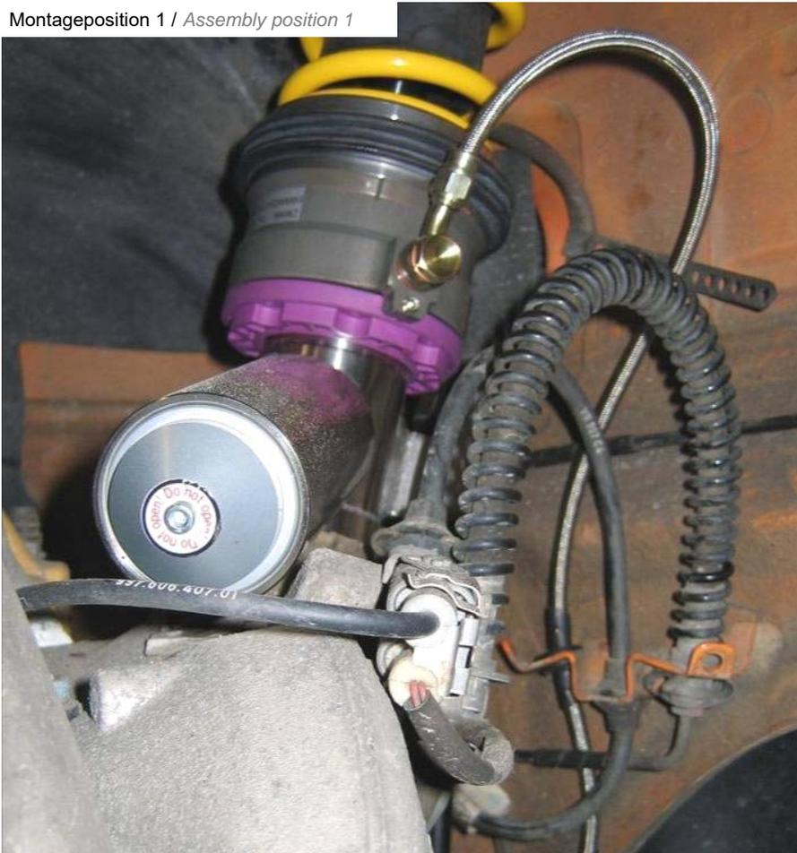
Hydraulikleitung (1200 mm) am HLS Ringzylinder mit der mitgelieferten Hohlschraube und 2 Dichtscheiben montieren.
