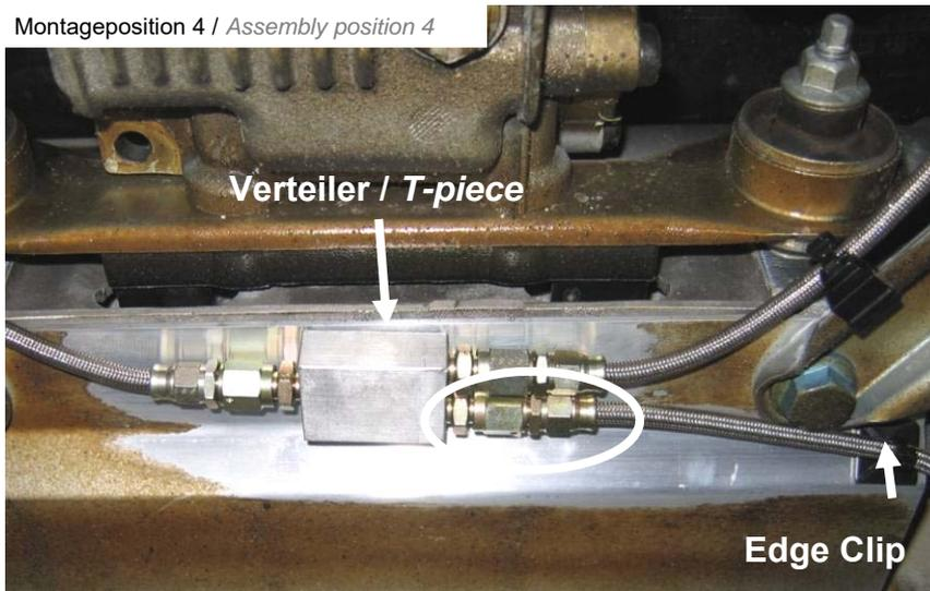
Hydraulikleitung (2400 mm) mit dem Verteiler verbinden. Anschließend Hydraulikleitung mit den bereits montierten Edge Clips an den Streben befestigen. Sollte es vorkommen, dass die Hydraulikleitung über einer Scharfen Kante verläuft ist die Hydraulikleitung mit dem Spiralband zu schützen.
