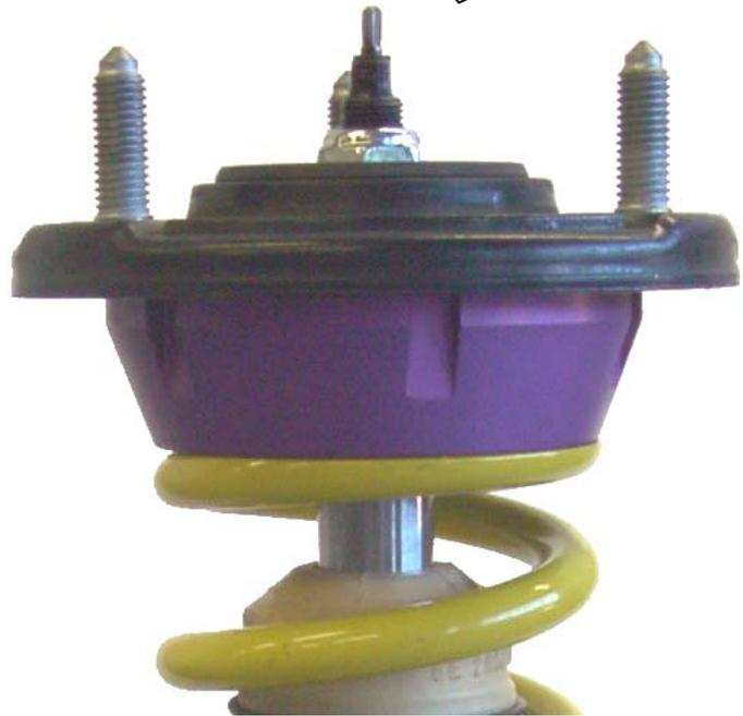
**Das Federbein muss so positioniert werden, dass der Dämpferausgleichsbehälter oberhalb der Antriebswelle liegt.**
