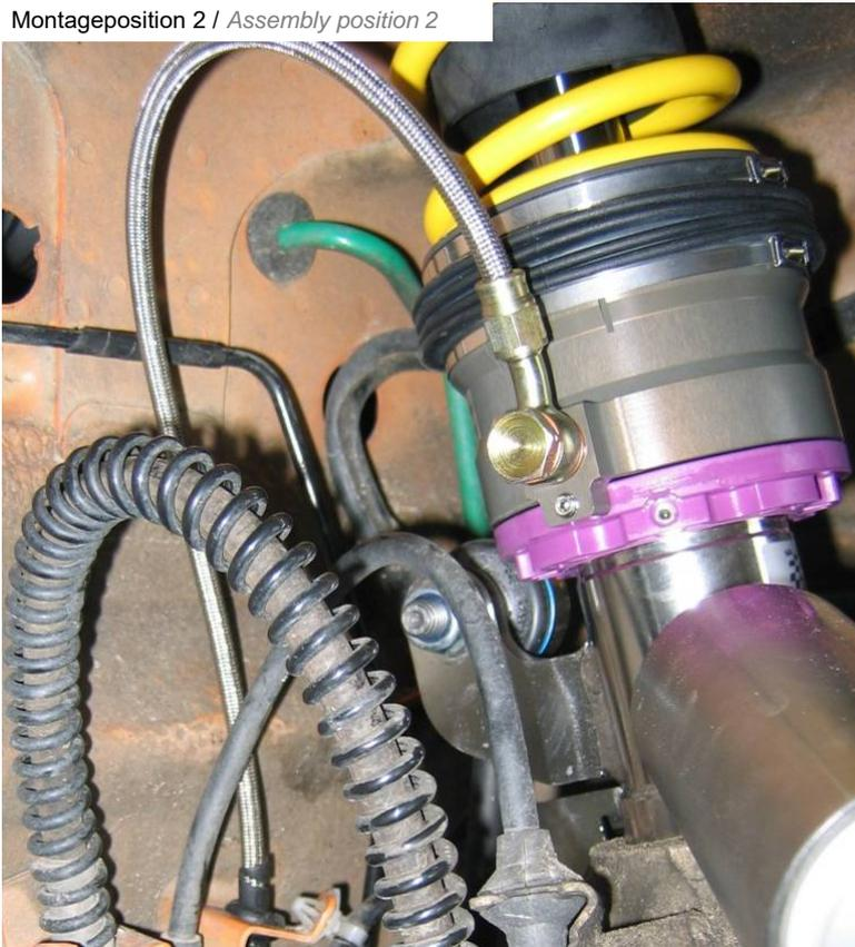
Hydraulikleitung (1200 mm) am HLS Ringzylinder mit der mitgelieferten Hohl-schraube und 2 Dichtschieben montieren.
