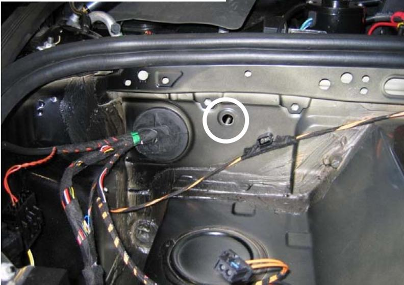
Mitgelieferte CAN Leitung in das HLS Steuergerät einstecken und Stecker verriegeln. CAN Leitung mit der mitgelieferten Kabeldurchführungsstülle in den Kofferraum verlegen.
