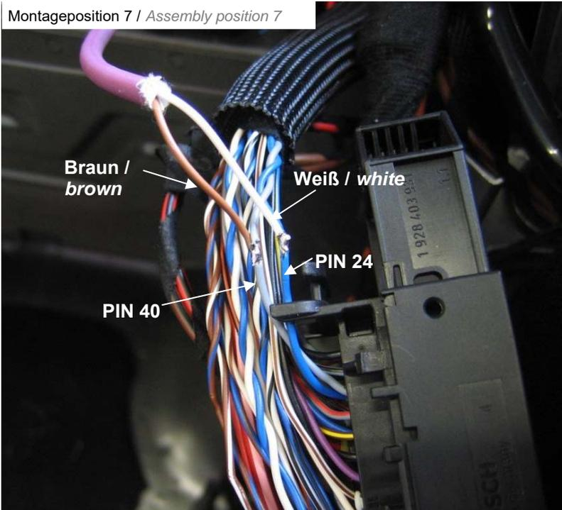
Isolation der Original CAN Leitung PIN 40 und PIN 24 abisolieren. Leitung nicht durchtrennen. Anschließend mitgelieferte CAN Leitung Leitungsfarbe „**braun**“ an Leitung **PIN 40** und Leitungsfarbe „**weiß**“ an **PIN 24** anlöten.
