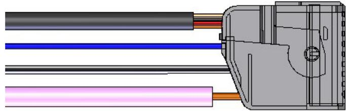
Zunächst muss herausgefunden werden, um welches Signal es sich beim Fahrzeug handelt. Dies ist an der Belegung am Radiostecker zu erkennen (siehe Bilder). Sind diese Leitungen am Stecker vorhanden, handelt es sich um die jeweilige Signalart.
