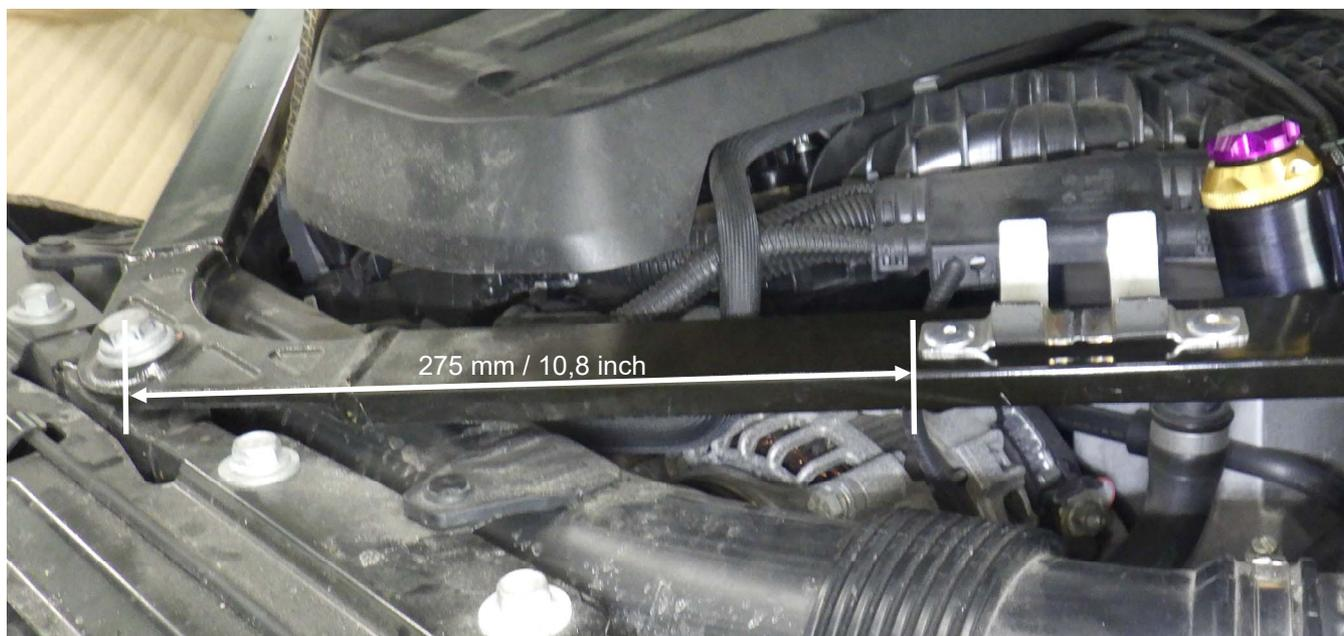
Ausgleichsbehälter mit Kabelbindern am Halter befestigen. **Anschließen Motorhaube vorsichtig schließen und prüfen ob ausreichend Abstand zwischen Motorhaube und Ausgleichsbehälter besteht.** Zusätzlich die Leitung mit einer Kabelbinder an der Strebe befestigen.
