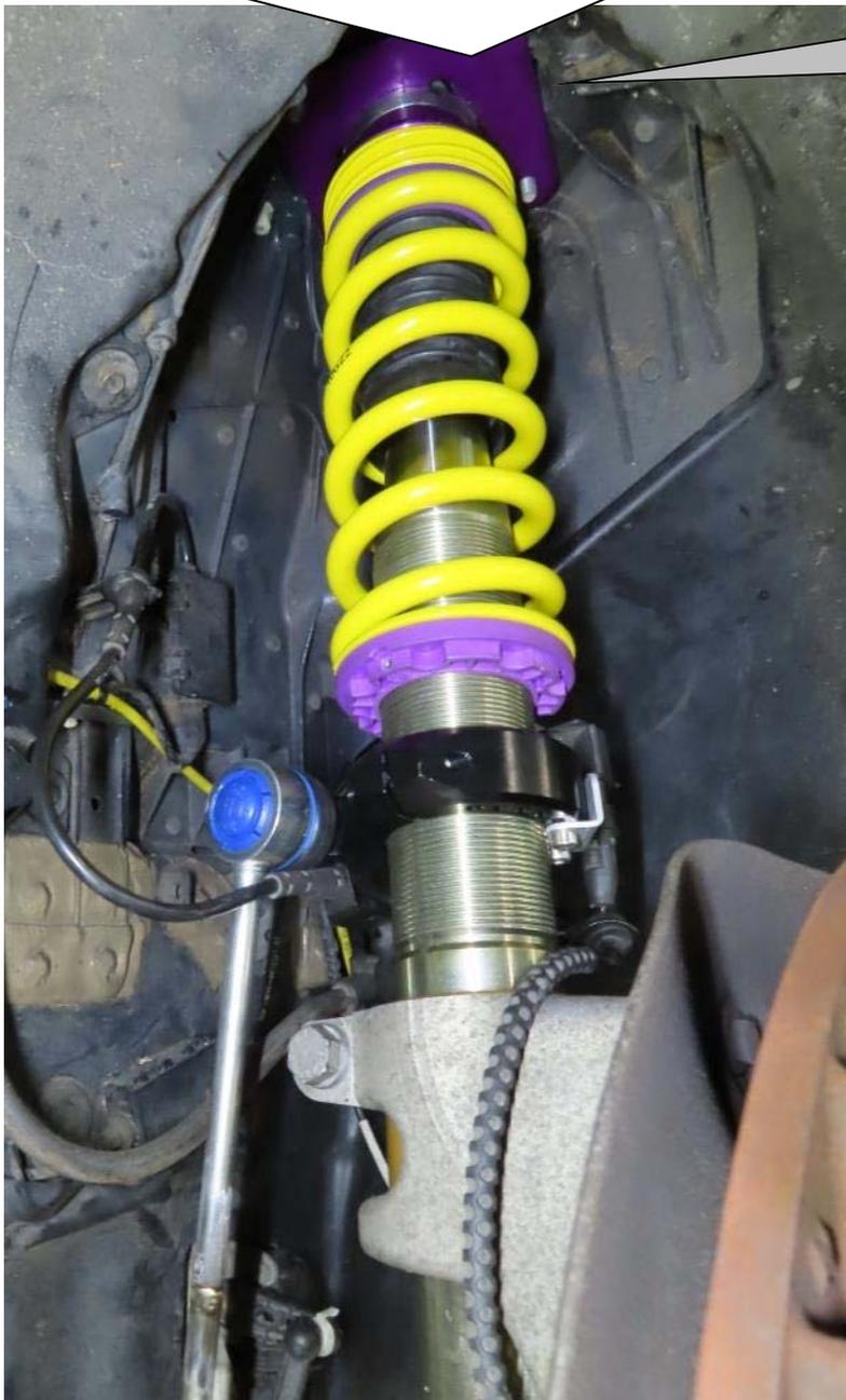
**Das Anzugsdrehmoment der Domlager-schrauben beträgt 25 Nm.**
