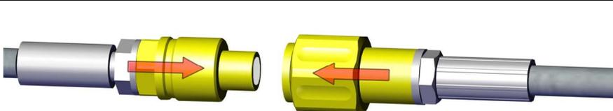
Kupplung zusammenstecken und mit der Überwurfmutter sichern.
