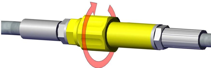
Anzugsdrehmoment der Schraubverbindung beträgt 15Nm.
