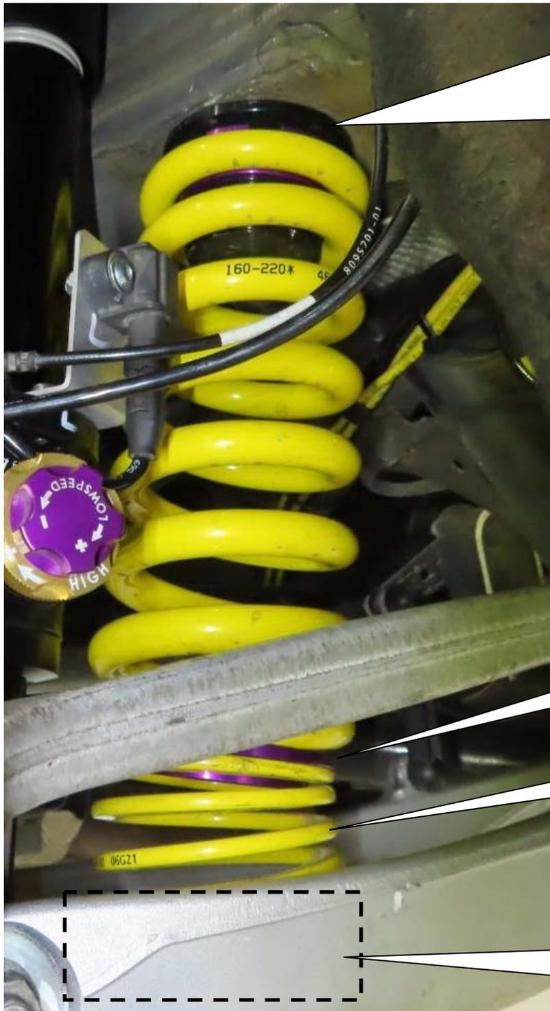
Die HA-Verstellung wird oben zwischen Feder und Karosserie montiert. Die serienmäßige Federunterlage entfällt. Zum Korrigieren (verdrehen des Gewinderings) der Fahrzeughöhe, ist die HA-Verstellung aus dem Fahrzeug zu demontieren. Achtung: Vor dem Einsetzen der Höhenverstellung müssen die Berührungsflächen gereinigt werden.
