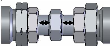
Bei Fahrzeug mit Höhensensoren muss vor der Demontage der Abstand (H) des Höhensensors ausgemessen werden. Nach der Montage muss der Abstand so eingestellt werden, wie zuvor gemessen.
