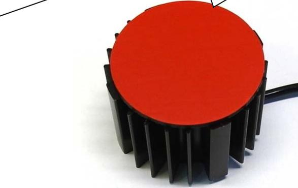
Leitungen der Stilllegungen an den offenen Kabeln vom Stecker einstecken. Auf die korrekte Verriegelung der Stecker achten! Stilllegungen auf das Karosserieblech aufkleben. **WICHTIG: Oberfläche muss Staub- und Fettfrei sein.**
