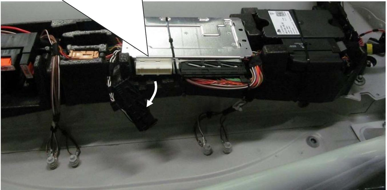
Mitgelieferten Stecker in das Steuergerät einstecken und verriegeln.
