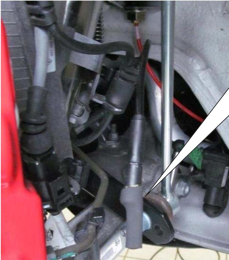
Kabelende mit einem Schrumpfschlauch oder Klebeband wasserdicht verschließen.
