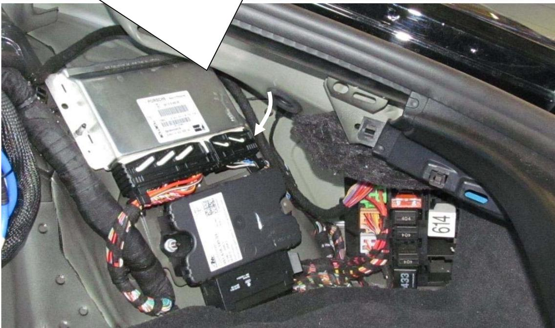
Mittelgelieferten Stecker in das Steuergerät einstecken und verriegeln.
