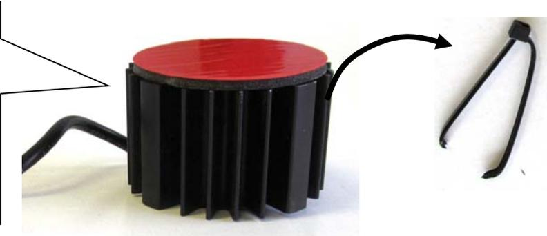
Originale Dämpfersteuerungsleitung in die mitgelieferten Stilllegung einstecken. Auf die korrekte Verriegelung des Steckers achten! Stilllegung mit dem mitgelieferten Klebe pad auf der Abdeckung befestigen.
