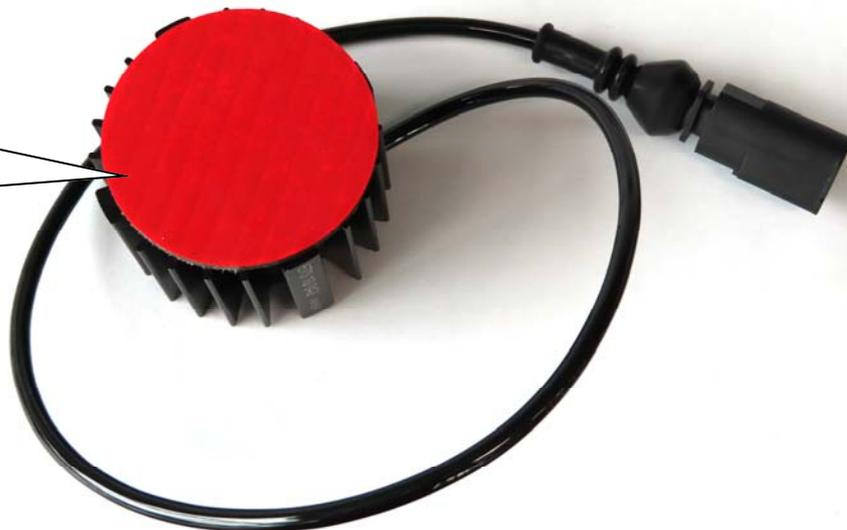
Dämpfersteuerungsleitung in den mitgelieferten Elektroniksatz einstecken. Auf die korrekte Verriegelung des Steckers achten! Stilllegungen auf das Karosserieblech Fahrzeugmittig aufkleben. **WICHTIG: Oberfläche muss Staub- und Fettfrei sein.**
