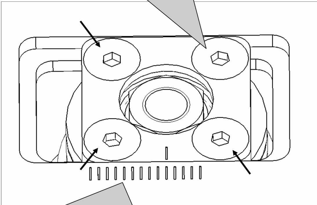
Einstellung: Uniballstützlager auf Mittelstellung montieren. Eventuelle Sturzeinstellung bei der Achsvermessung müssen an der unteren Federbeinverschraubung (Langloch) durchgeführt werden. Später Feineinstellungen sind ausschließlich am Uniballstützlager durchzuführen.
