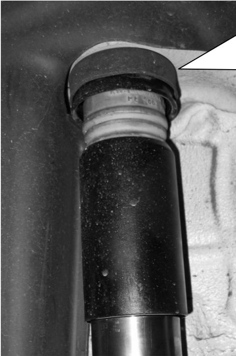
Für die Befestigung des Dämpfers im Fahrzeug verwenden Sie bitte oben die serienmäßigen Befestigungsmutter mit Scheibe. Die mitgelieferte Mutter dient nur als Transportsicherungen und kann nach erfolgtem Fahrwerkseinbau entsorgt werden. Das Anzugsdrehmoment der Kolbenstangenbefestigung beträgt 20 Nm. Die Montagehinweise zum Einbau des Dämpfers in das Fahrzeug entnehmen Sie bitte den Unterlagen des Fahrzeugherstellers.
