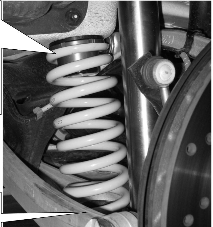
Am unteren Ende der Feder wird die Original Federunterlage weiterverwendet.
