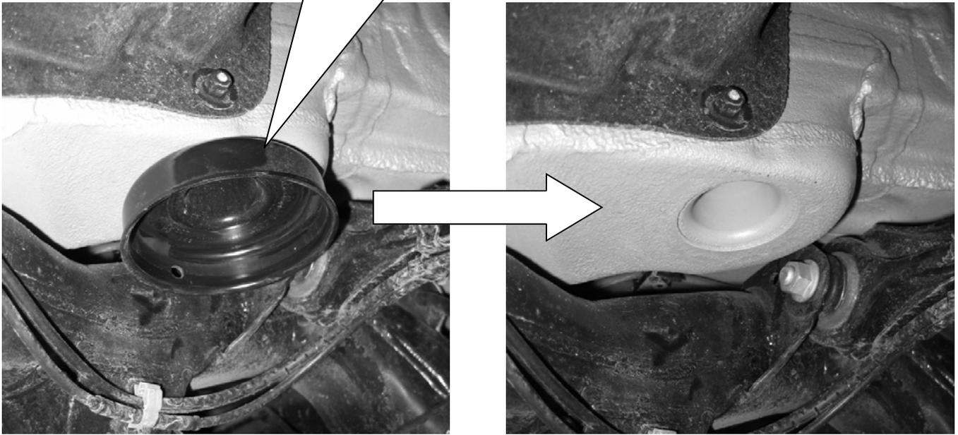
Die HA-Verstellung wird oben zwischen Feder und Karosserie montiert. Die serienmäßige Federunterlage entfällt. Zum Korrigieren (verdrehen des Gewinderings) der Fahrzeughöhe, ist die HA-Verstellung aus dem Fahrzeug zu demontieren.
