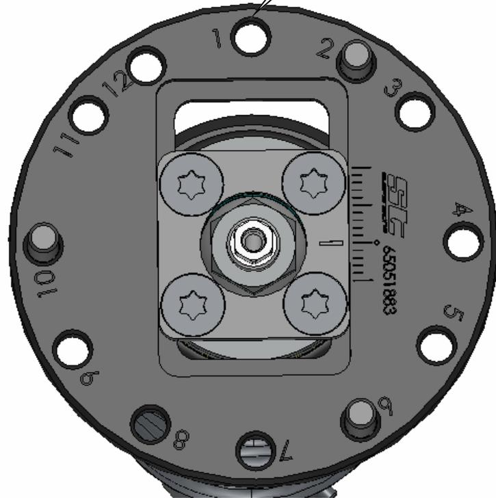
Einstellung: Uniballstützlager auf Mittelstellung montieren. Eventuelle Sturzeinstellung bei der Achsvermessung müssen an der unteren Federbeinverschraubung (Langloch) durchgeführt werden. Später Feineinstellungen sind ausschließlich am Uniballstützlager durchzuführen.
