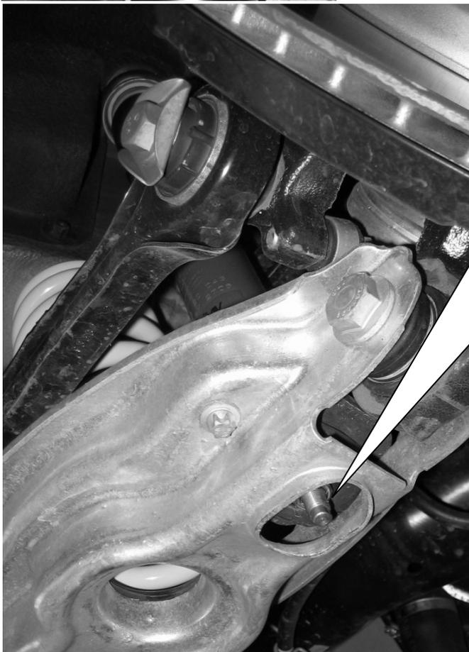
Das Anzugsdrehmoment der unteren Dämpferbefestigung beträgt 30 Nm.
