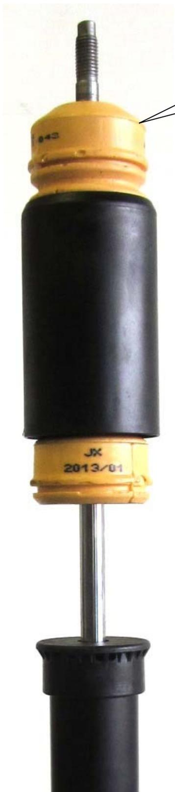
Anschlagelement mit Staubschutzrohr auf den Dämpfer aufstecken.
