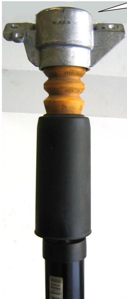
Staubschutzrohr und Anschlagelament entfernen. Diese werden nicht mehr benötigt.
