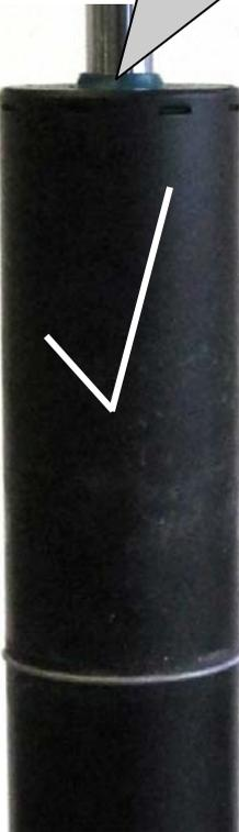
Mitgelieferte Gewindehülse 1, Gewinding mit Adapter 2 und die Original Entlüfterscheibe 3 auf das Federbein aufstecken.
