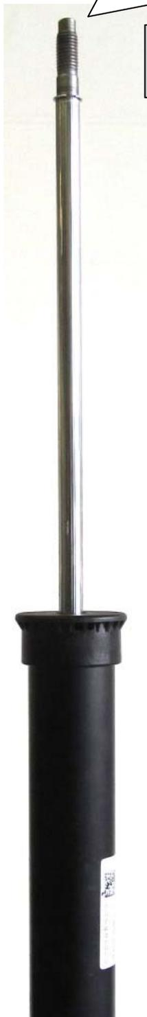
Mitgeliefertes Anschlagelament auf den Dämpfer aufstecken.
