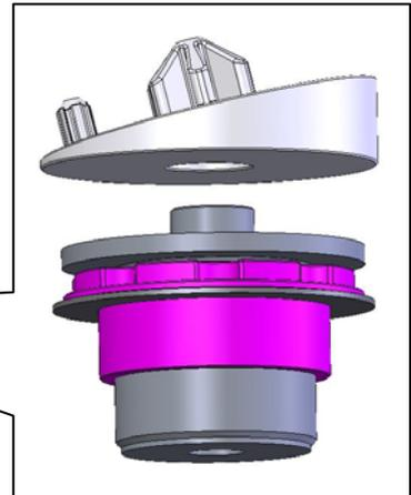
Die Höhenverstellung mit Adapter und Scheibe wird oben eingesetzt, die serienmäßige obere Federunterlage wird nicht mehr verwendet. .
