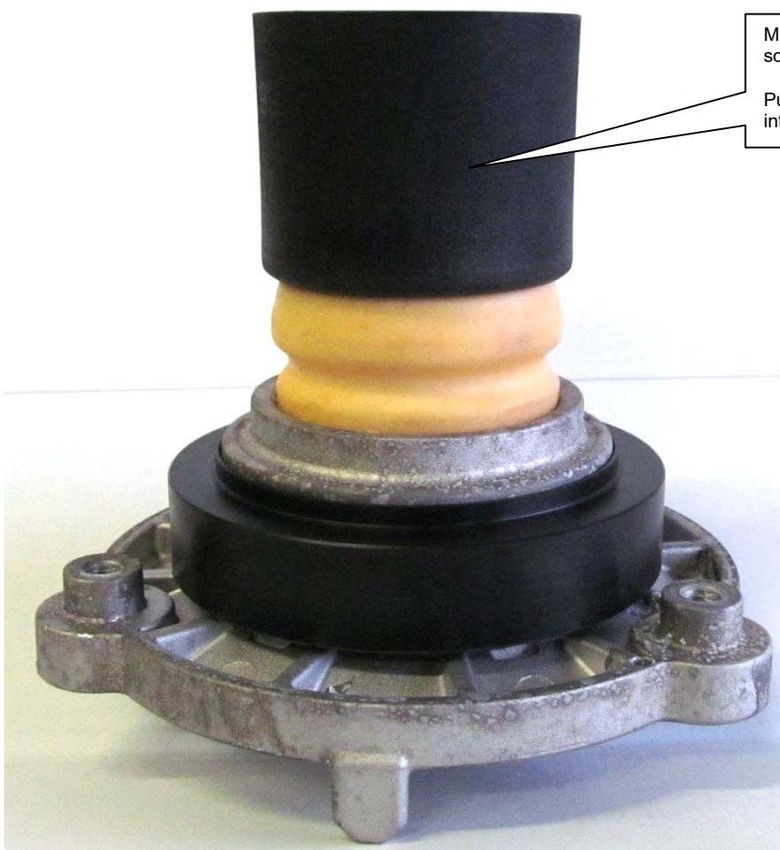
Mitgelieferter Federwegsbegrenzer + Staubschutzrohr in das Stützlager eindrücken.
