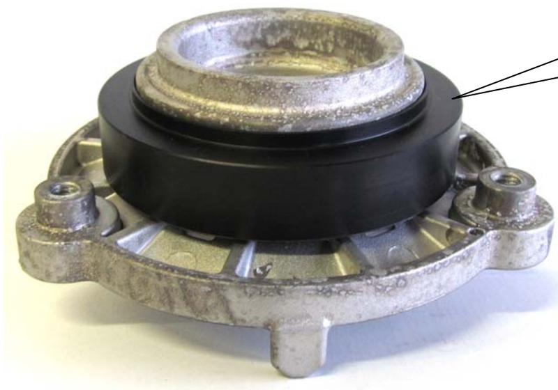
Federadapter auf das original Stützlager aufstecken.
