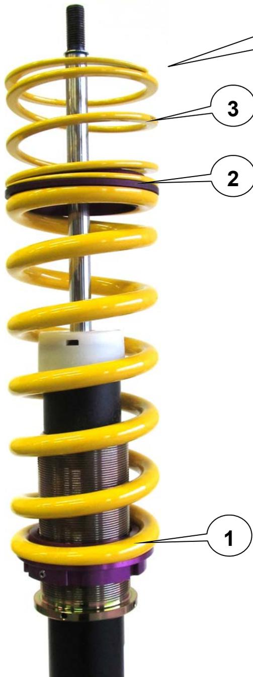
Folgende mitgelieferte Teile in der Reihenfolge auf das Federbein aufstecken: Hauptfeder 1, Zwischenring 2 und Vorspannfeder 3.
