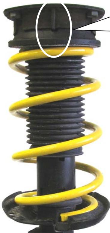
Feder und Stützlager auf den Dämpfer aufstecken und nach Herstellerangaben montieren.
