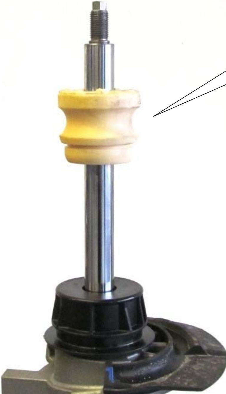
Original Anschlagelament gegen das mitgelieferte Anschlagelament austauschen. Das Original Anschlagelament wird nicht mehr benötigt.
