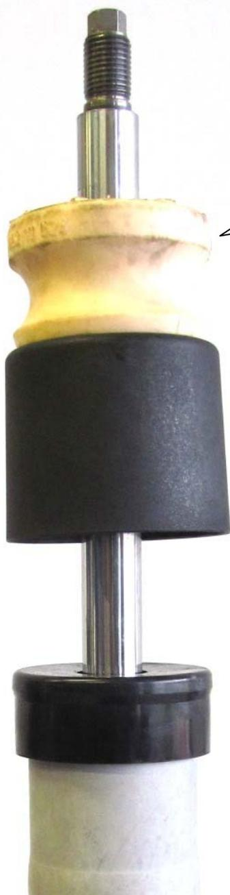
Original Anschlagelament und Staubschutzrohr gegen das mitgelieferte Anschlagelament mit Staubschutzrohr austauschen. Das Original Anschlagelament und Staubschutzrohr wird nicht mehr benötigt.
