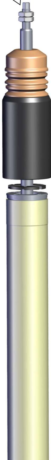
Stützlager vom Serienfahrzeug auf den angelieferten Dämpfer montieren. Das Anzugsdrehmoment der Kolbenstangenbefestigung beträgt 20 Nm. Die Montagehinweise zum Einbau des Dämpfers in das Fahrzeug, sowie die Anzugsdrehmomente der Dämpferbefestigung, entnehmen Sie bitte den Unterlagen des Fahrzeugherstellers.
