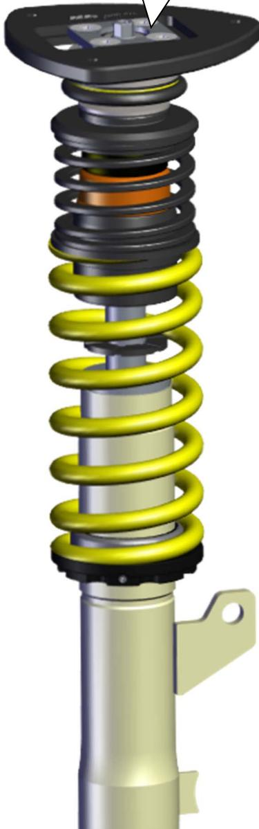
Das Anzugsdrehmoment der oberen Dämpferbefestigung beträgt 25 Nm. Die Montagehinweise zum Einbau des Federbeines in das Fahrzeug, sowie die Anzugsdrehmomente der Federbeinbefestigung, entnehmen Sie bitte den Unterlagen des Fahrzeugherstellers.
